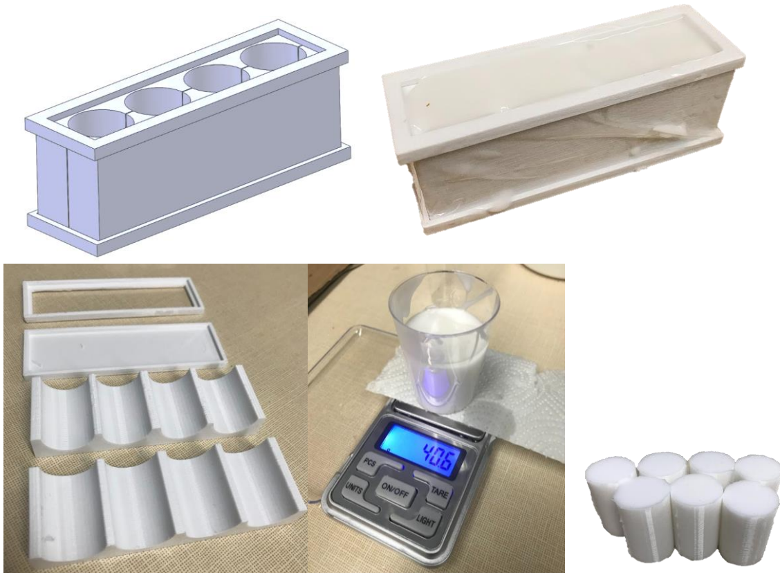
Obrázek 38 Forma a odlitky vzorků pro zjištění materiálových vlastností, příprava silikonu
