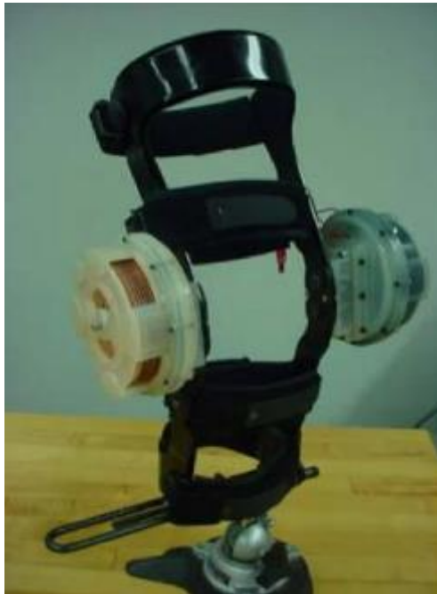
Obrázek 13 Exoskeleton založený na elektroeologické kapalině[38]
