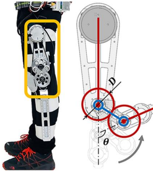
Obrázek 14 Exoskeleton s převodovým systémem [39]
