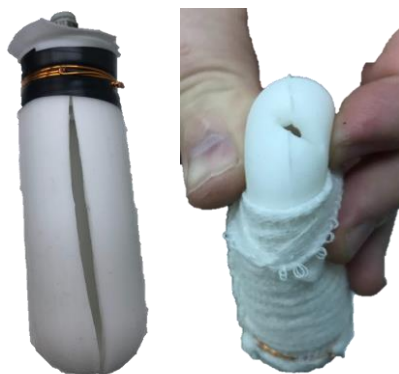
Obrázek 51 Trhliny vzniklé při pokusu u nezpevněného a zpevněného vzorku
