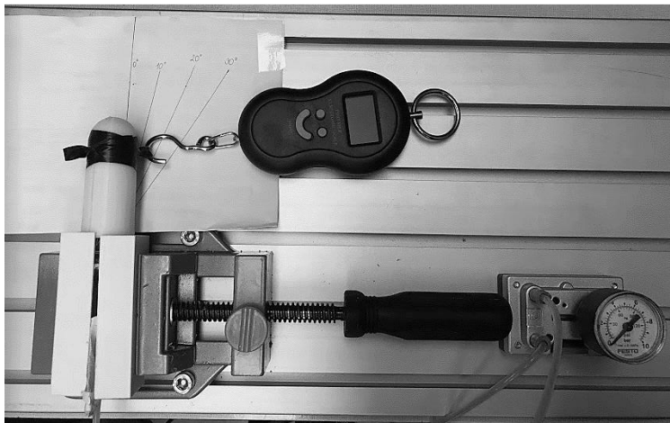
Obrázek 43 Část pneumatického systému a umístění redukční vložky v aktuátoru
