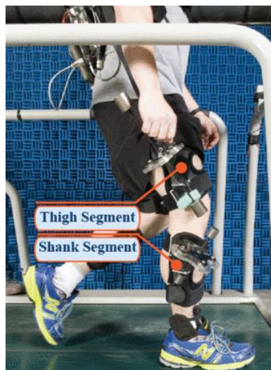
Obrázek 17 Exoskeleton vybavený dvěma pružinami [47]
