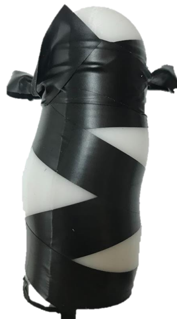
Obrázek 44 Nafouknutý aktuátor tlakem 75 kPa v obinadle a bez, zpevněný aktuátor páskou
