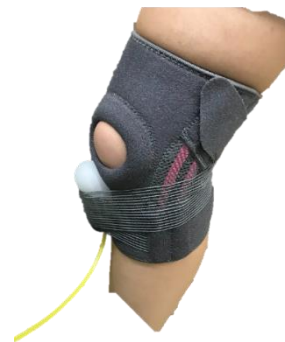
Obrázek 50 Upínací mechanismus umělého kolena, aktuátor umístěný na skutečném kolenním kloubu
