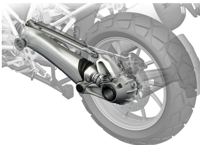
Obr. 6 Sekundární pohon kardanovým hřídelem
