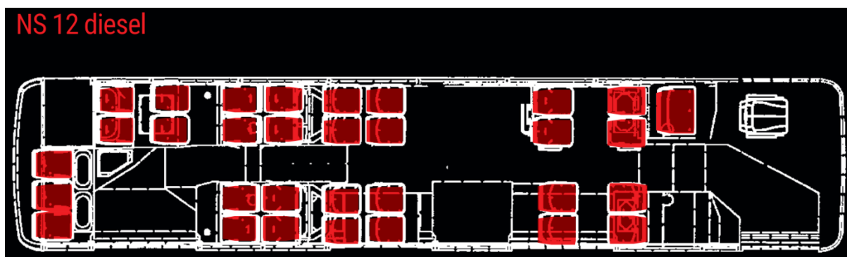
Obrázek č. 5: Plán interiéru vozu SOR NS 12
