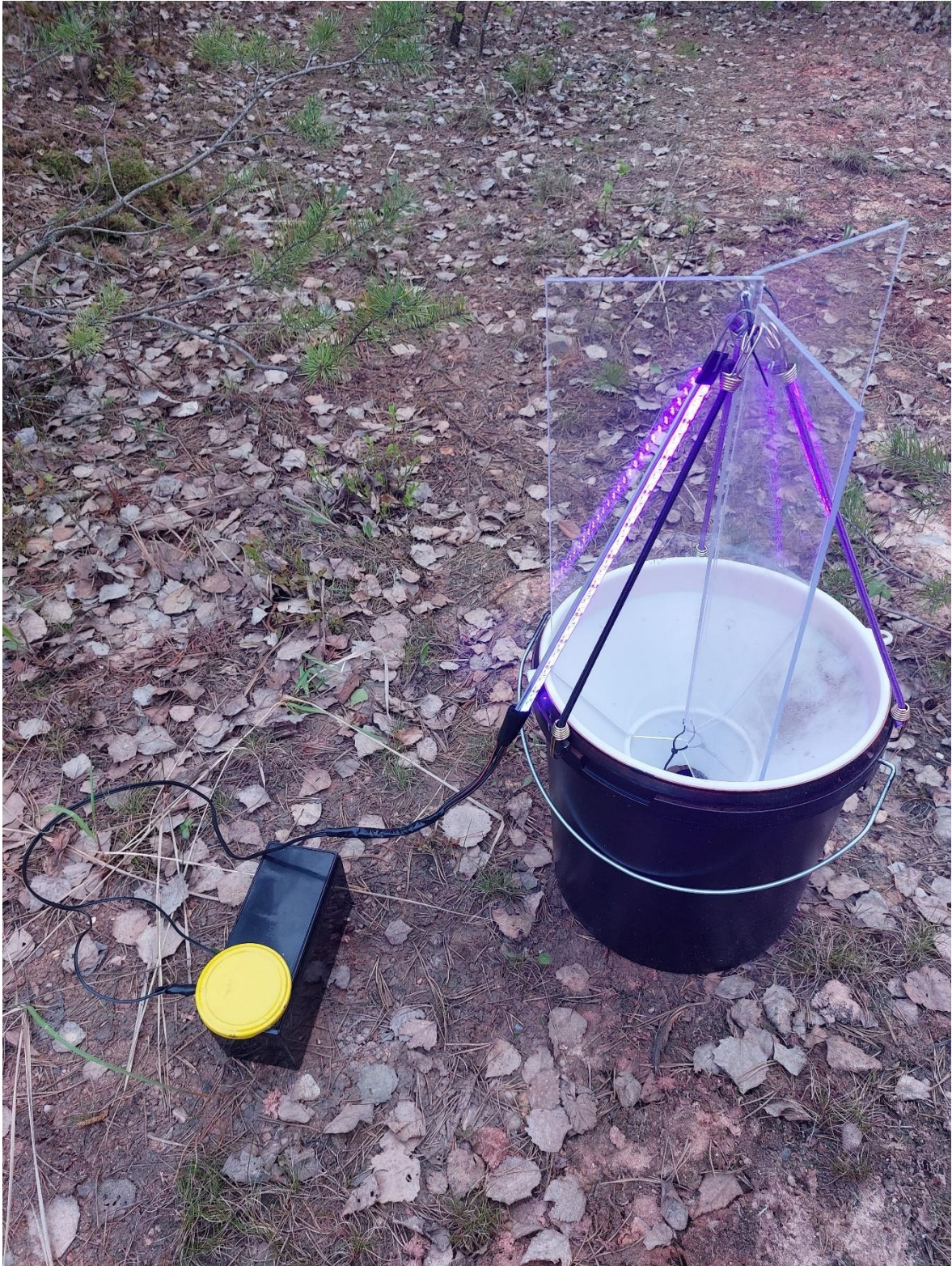
Obr. K. Sestavený lapač, připravený na odchyt na stanovišti v aktivní části kaolinového lomu, detail. Foto: Eva Šlaufová.
