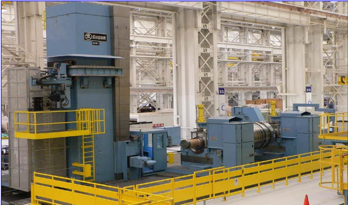
Obr. 28 – Obrábění rotoru plynové turbíny
