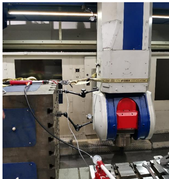
Obr. 54 - Měřicí stanoviště pro měření deformaci ve směru osy Y – zatěžování přes upínač nástrojů vlevo, zatěžování přes smykadlo vpravo
