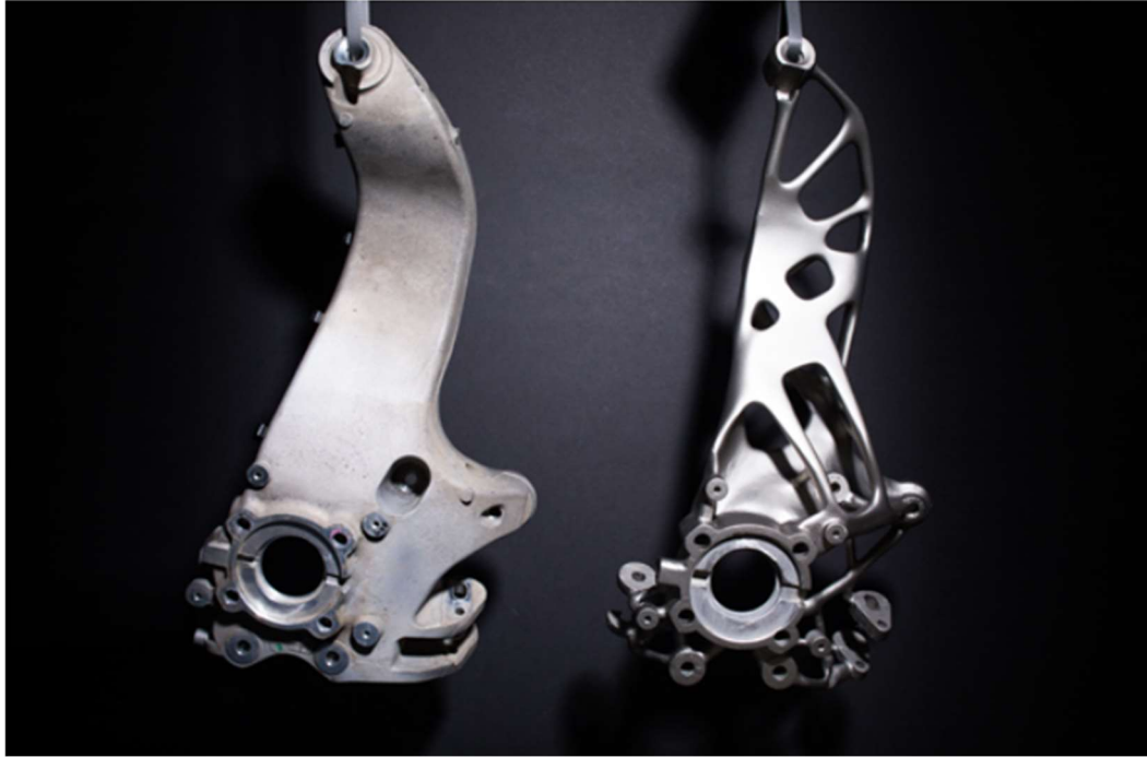
Obrázek 75 Optimalizovaná část nápravy automobilu vyrobená přímo z výsledku TO [40]
