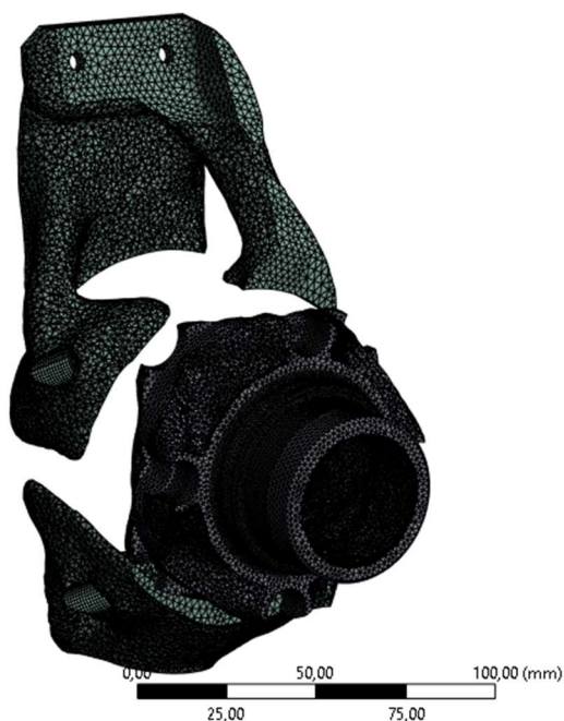
Obrázek 38 Optimalizovaná geometrie Level-set based optimalizace s cílem min. poddajnosti
