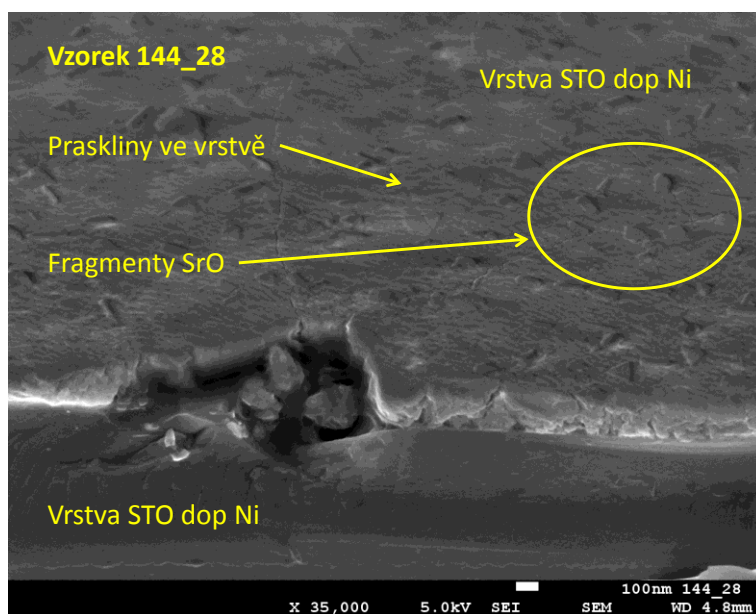
Obrázek č. 44 – Pohled pod úhlem 45°, zvětšení 35 000x, patrné praskliny v povrchu tenké vrstvy, fragmenty fáze Ni(TiO 3 ).
