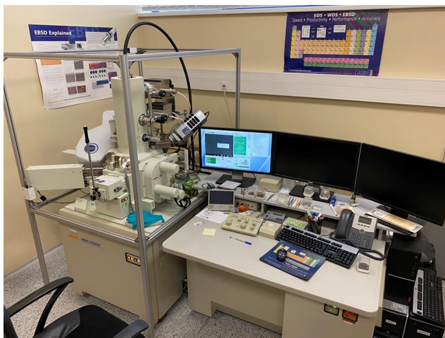
Obrázek č. 27: Skenovací elektronový mikroskop JSM-7600F JEOL.
