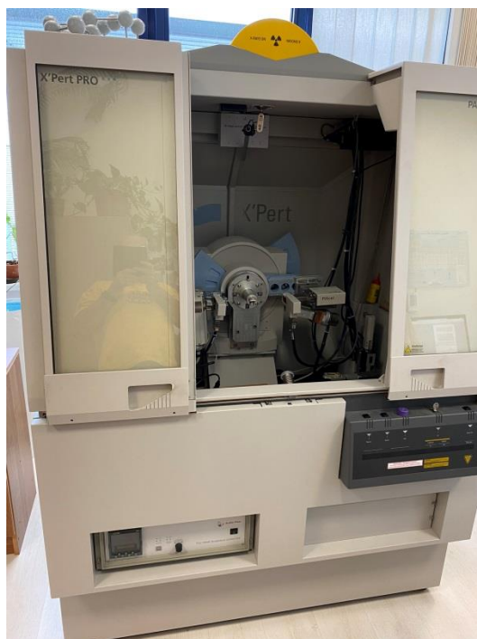
Obrázek č. 25 - Práškový difraktometr Panalytical X'Pert Pro pro analýzu rentgenové difrakce.
