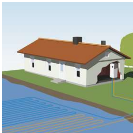
Obrázek 17: Tepelné čerpadlo voda – voda s plošným kolektorem [5]
