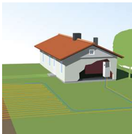
Obrázek 14: Tepelné čerpadlo země – voda s plošným kolektorem [5]
