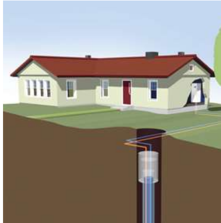
Obrázek 15: Tepelné čerpadlo země – voda se zemním vrtem [5]
