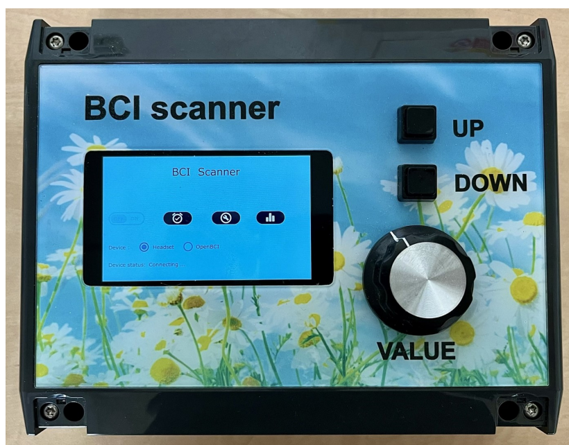
Obrázek 3.4: BCI scanner obsahující mikrokontrolér, který slouží jako centrální komunikační prvek BCI systému
