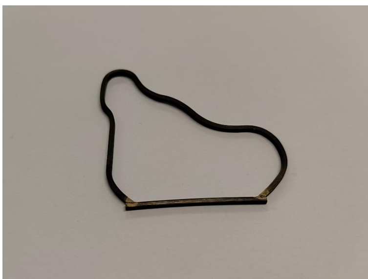
Obr. 45 Sletovaný kus konstrukce
