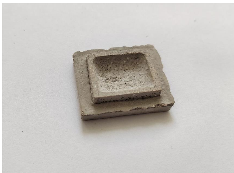
Obr. 30 Upravený kousek betonu zalit podruhé
