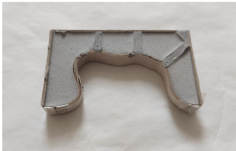
Obr. 29 Beton zalitý ve formě
