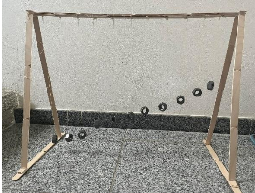
Obrázek 23: Machův vlnostroj – rozdílná délka závěsů, zdroj: autor
