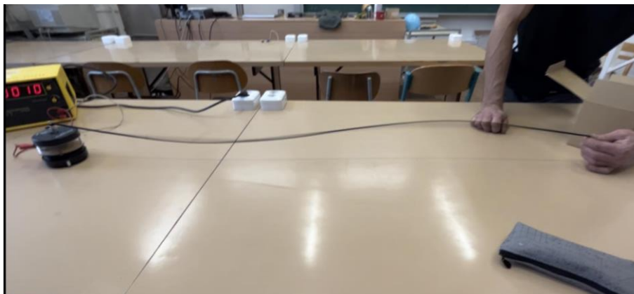
Obrázek 15: Příčné stojaté vlnění na šnůře a krokovém motoru, zdroj: autor
