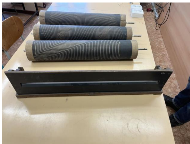
Obrázek 19: Válcový vlnostroj, horní válec znázorňuje podélnou stojatou vlnu a zbylé dva válce znázorňují postupné podélné vlnění, zdroj: autor
