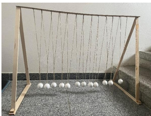
Obrázek 22: Machův vlnostroj – stejná délka závěsů, zdroj: autor
