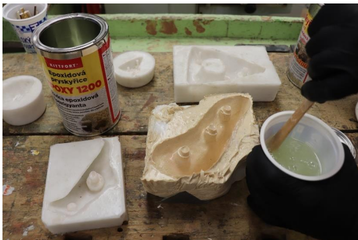
Obr. 10 – Míchání epoxidu (vlastní zdroj)
