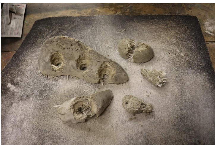
Obr. 30 – Poškozené betonové chyty (vlastní zdroj)
