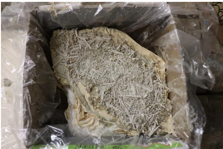
Obr. 22 – Tvrdnutí chytu z betonu (vlastní zdroj)
