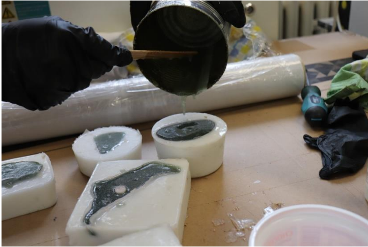
Obr. 16 – Vylévání chytů z polyesteru (vlastní zdroj)
