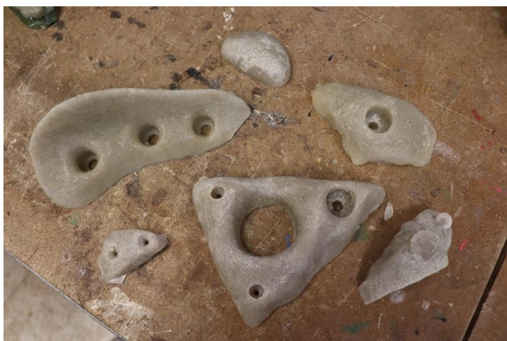
Obr. 14 – Sada chytů z epoxidu s pískem (vlastní zdroj)
