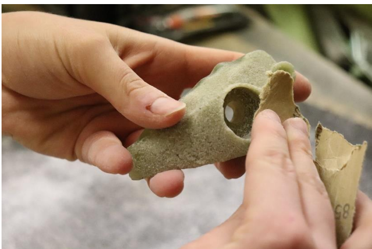
Obr. 33 – Odbrušování detail 1 (vlastní zdroj)
