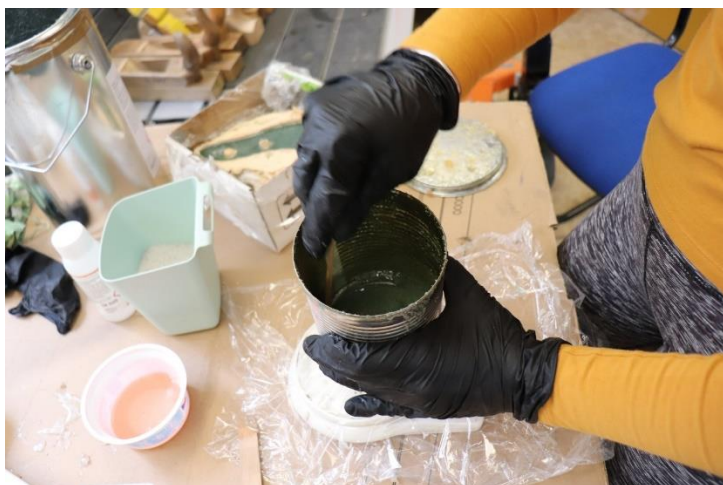
Obr. 15 – Míchání polyesteru s pískem (vlastní zdroj)
