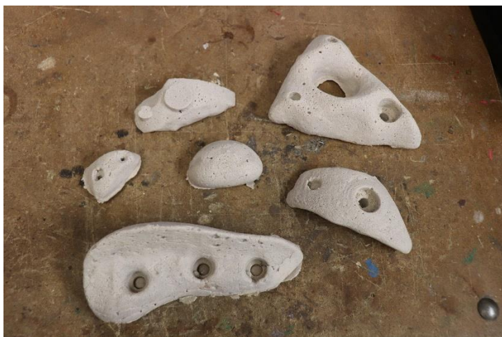
Obr. 20 – Sada z polyuretanu s pískem (vlastní zdroj)
