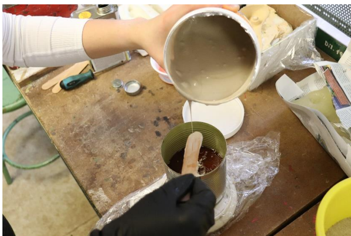
Obr. 19 – Míchání polyuretanu (vlastní zdroj)
