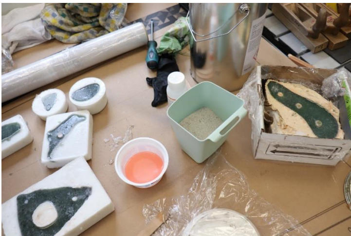
Obr. 17 – Vylité chyty, separátor, písek (vlastní zdroj)
