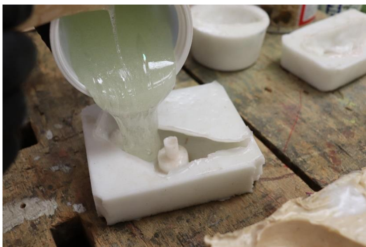
Obr. 11 – Vylévání epoxidu (vlastní zdroj)
