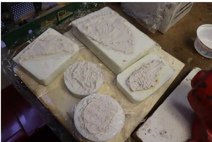
Obr. 21 – Tvrdnutí chytů ze sádry (vlastní zdroj)
