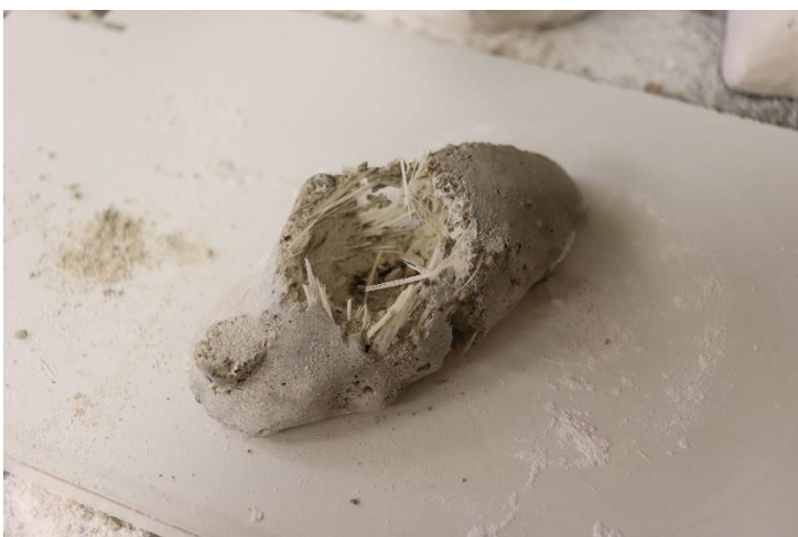
Obr. 29 – Vydrolený chyt (vlastní zdroj)
