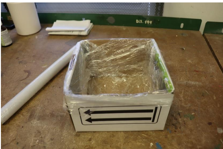
Obr. 6 – Fólie proti rozmočení (vlastní zdroj)
