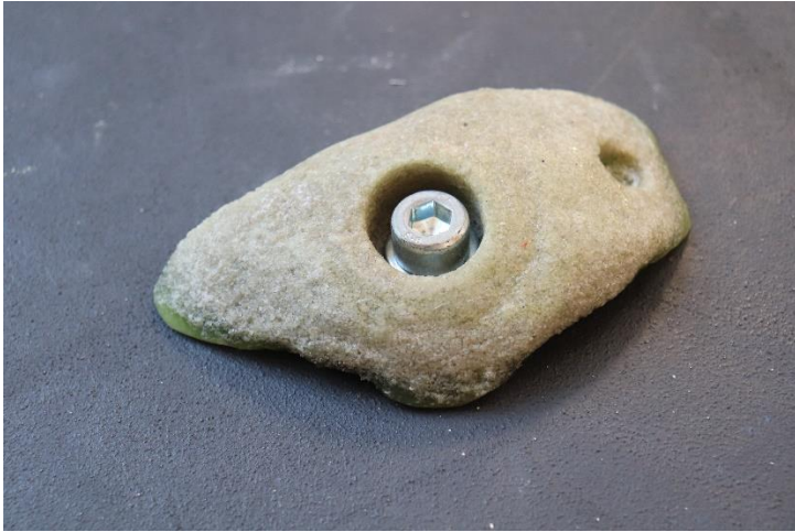
Obr. 42 – Finální podoba chytu „placka“ z epoxidu s pískem (vlastní zdroj)
