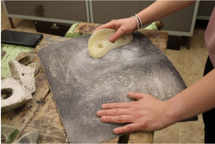
Obr. 24 – Broušení chytu „velký dlouhý“ brusným papírem (vlastní zdroj)
