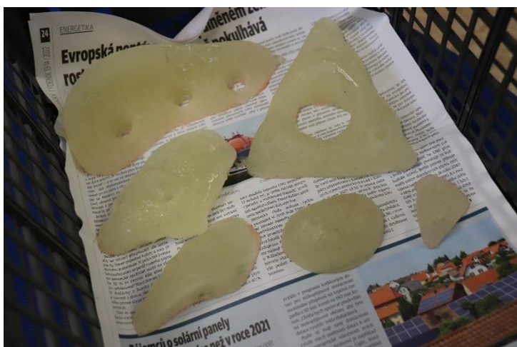
Obr. 13 – Nezatvrdlé chyty (vlastní zdroj)
