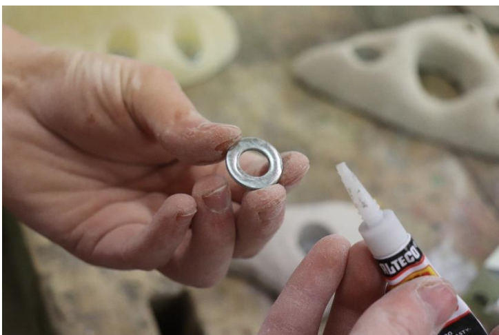
Obr. 35 – Lepení podložek (vlastní zdroj)
