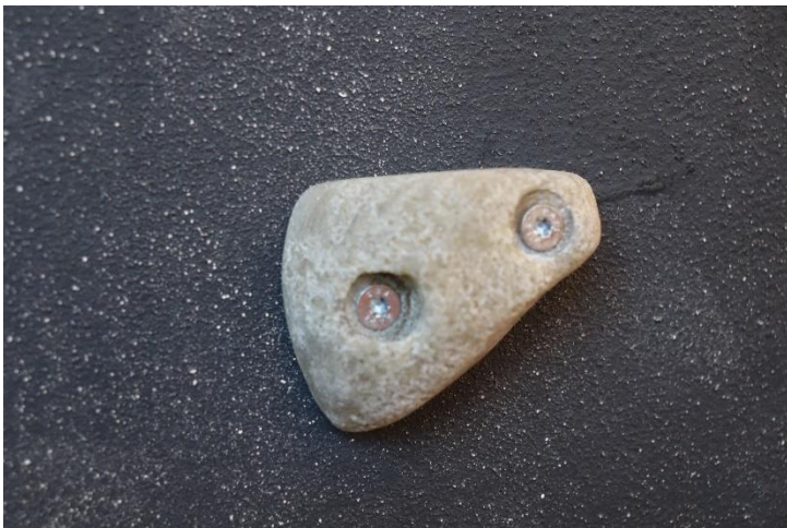
Obr. 41 – Finální podoba chytu „malý na nohu“ z epoxidu s pískem (vlastní zdroj)
