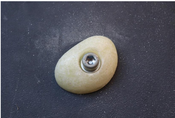
Obr. 40 – Finální podoba chytu „malá boule“ z epoxidu se skelným vláknem (vlastní zdroj)
