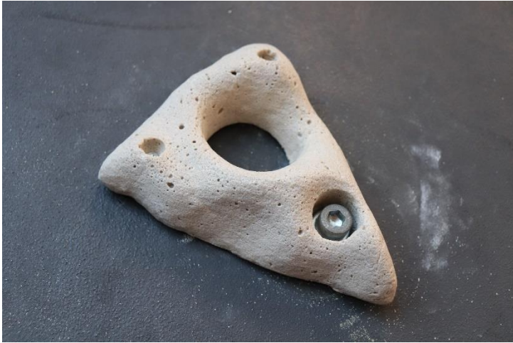
○ Obr. 39 – Finální podoba chytu „Trojúhelník s dírou uprostřed – pizza“ z polyuretanu s pískem (vlastní zdroj)
