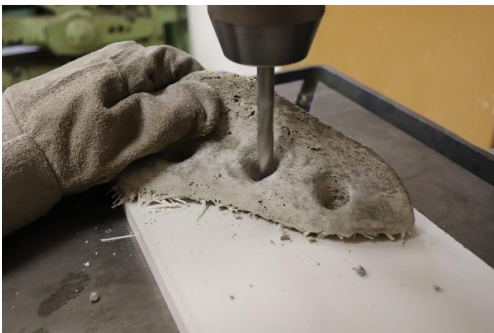
Obr. 25 – Vrtání chytu „velký dlouhý“ (vlastní zdroj)
