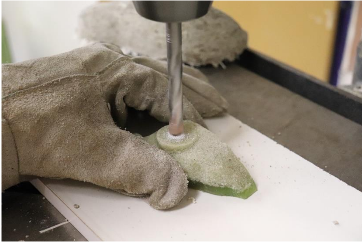
Obr. 26 – Vrtání chytu „malý dlouhý“ (vlastní zdroj)
