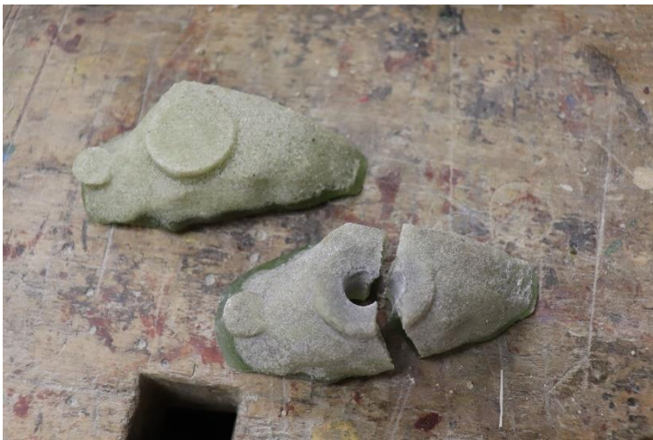
Obr. 27 – Prasklý a nový chyt „malý dlouhý“ (vlastní zdroj)
