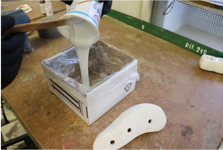
Obr. 8 – Odlévání formy (vlastní zdroj)
