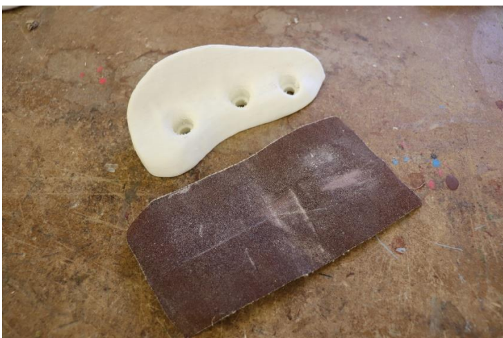
Obr. 5 – Zabroušení 3D chytů (vlastní zdroj)
