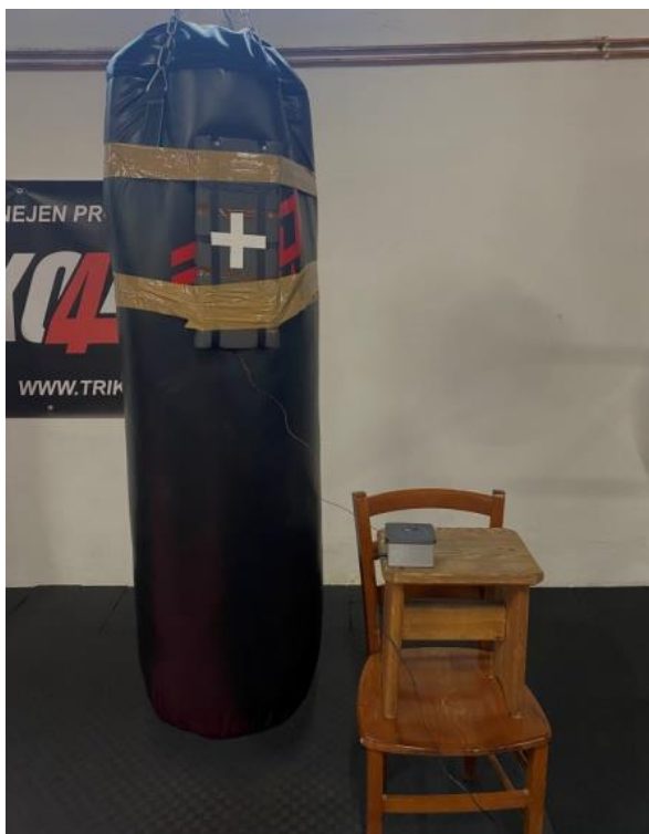
Obr. 16: Úderová deska připevněná k boxovacímu pytli a snímač úderů (na stolku)
