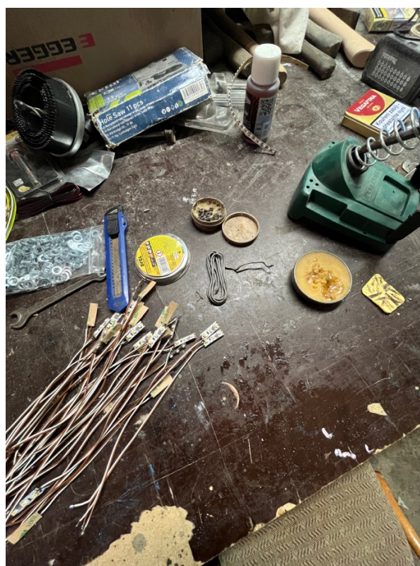
Obr. č. 13. – Letování Led světel s kabely
