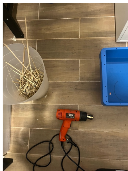
Obr. 30, Příprava na zahřívání napařených bambusových vláken pro ohýbání teplem horkovzdušné pistole (archiv autora)
