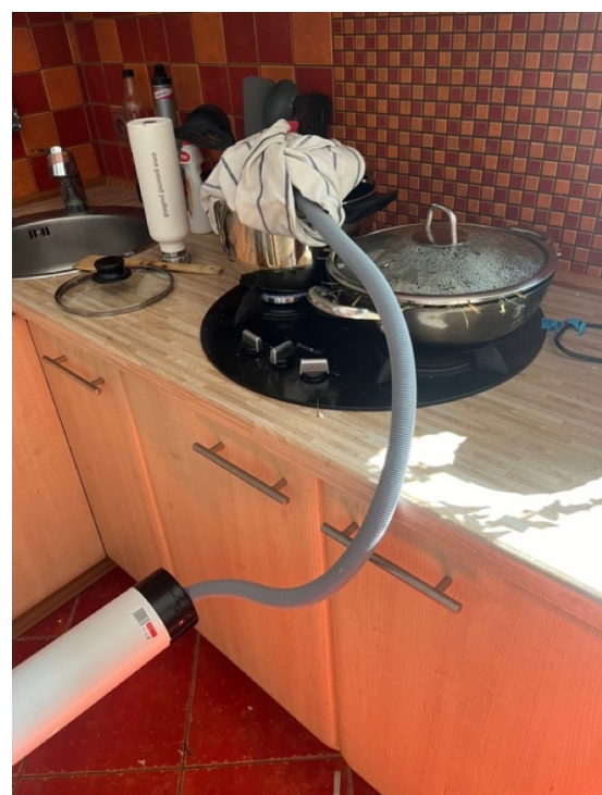
Obr. 43 a 44, Sestavené konstrukce pro napařování bambusu pomocí trubek a páry z hrnce (archiv autora)
