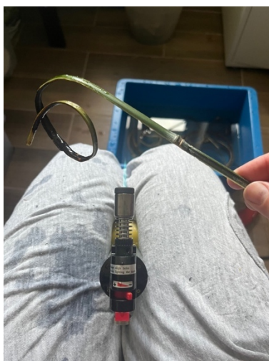
Obr. 51, Ohýbání napařených čerstvých bambusových vláken pomocí hořáku (archiv autora)
