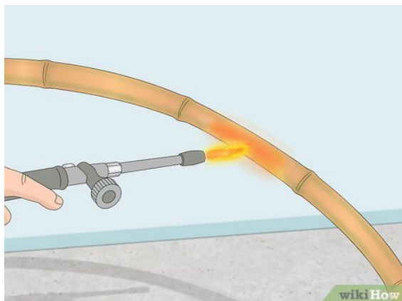
Obr. 29, Zahřívání bambusu pomocí hořáku před procesem ohýbání (WikiHow)
