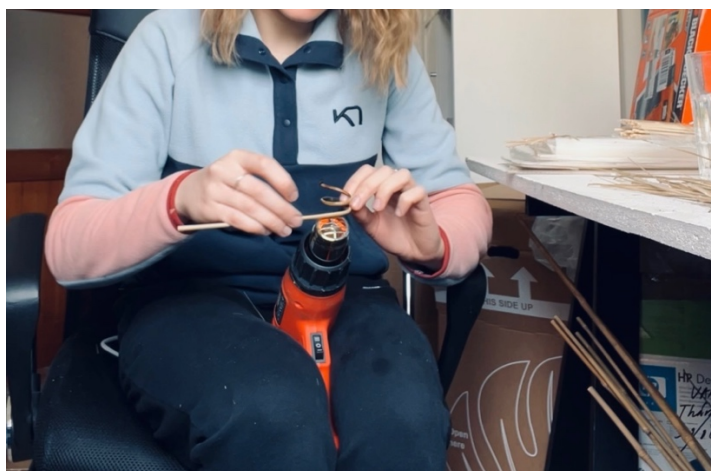
Obr. 52, Ohýbání napařených rok starých bambusových vláken pomocí horkovzdušné pistole (archiv autora)
