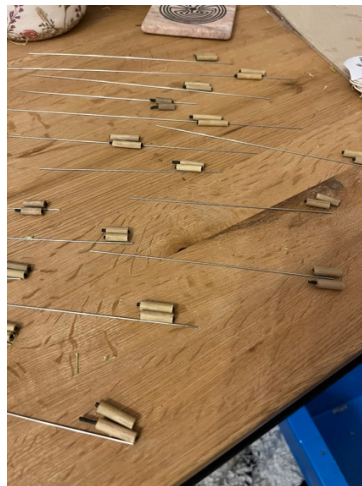
Obr. 65, Připravené zátky se zmenšenými bužírkami k jednotlivým jehlám (archiv autora)
