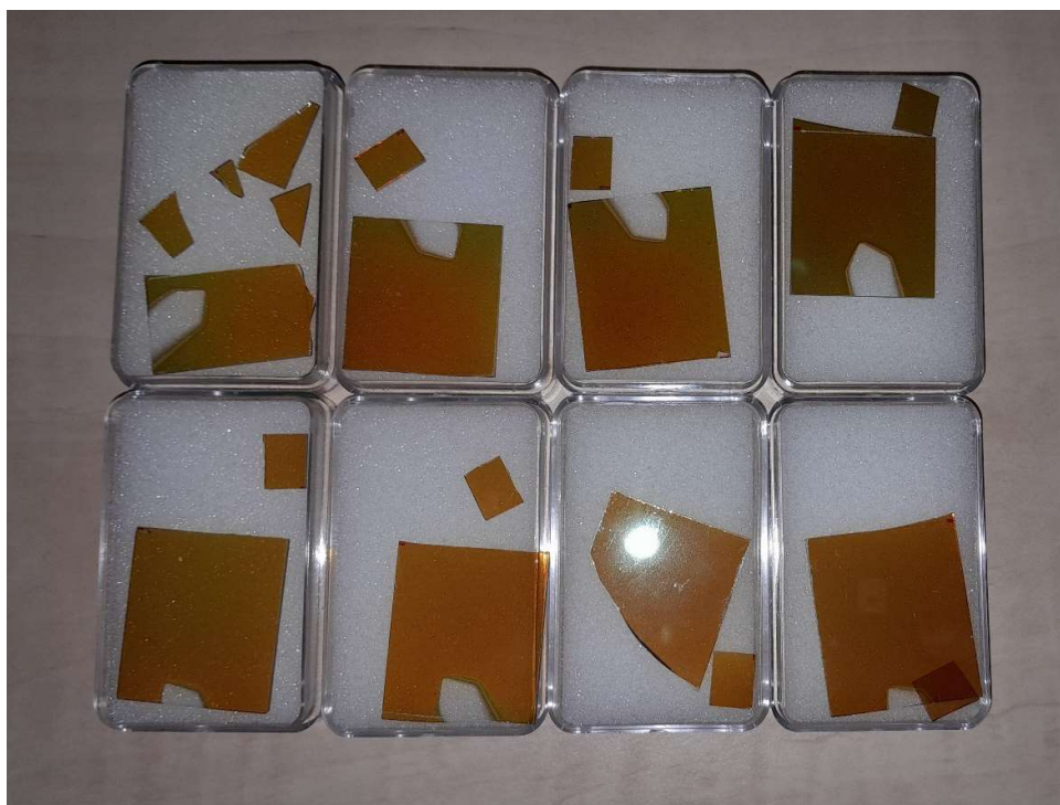
Obrázek 3: Měřené vzorky \text{Cu}_2\text{O} dopované dusíkem. V horní řadě jsou umístěny vzorky připravené při pokojové teplotě, ve spodní řadě vzorky připraveny při teplotě 300\text{ }^\circ\text{C} , směrem doprava se zvyšuje množství dusíku při přípravě.
