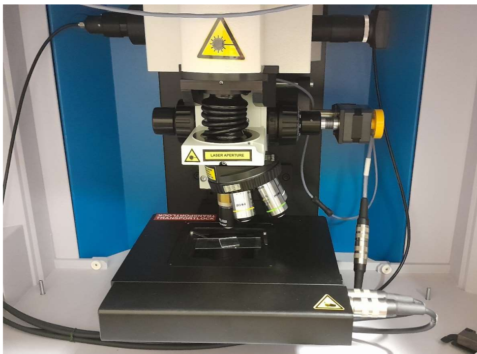
Obrázek 2: Vnitřní část Ramanova spektrometru použitého k měření vzorků. Měřená vrstva je umístěna na sklíčko pod mikroskop, shora je vysílán signál laseru zaznamenávan detektorem umístěným také nad vzorkem.
