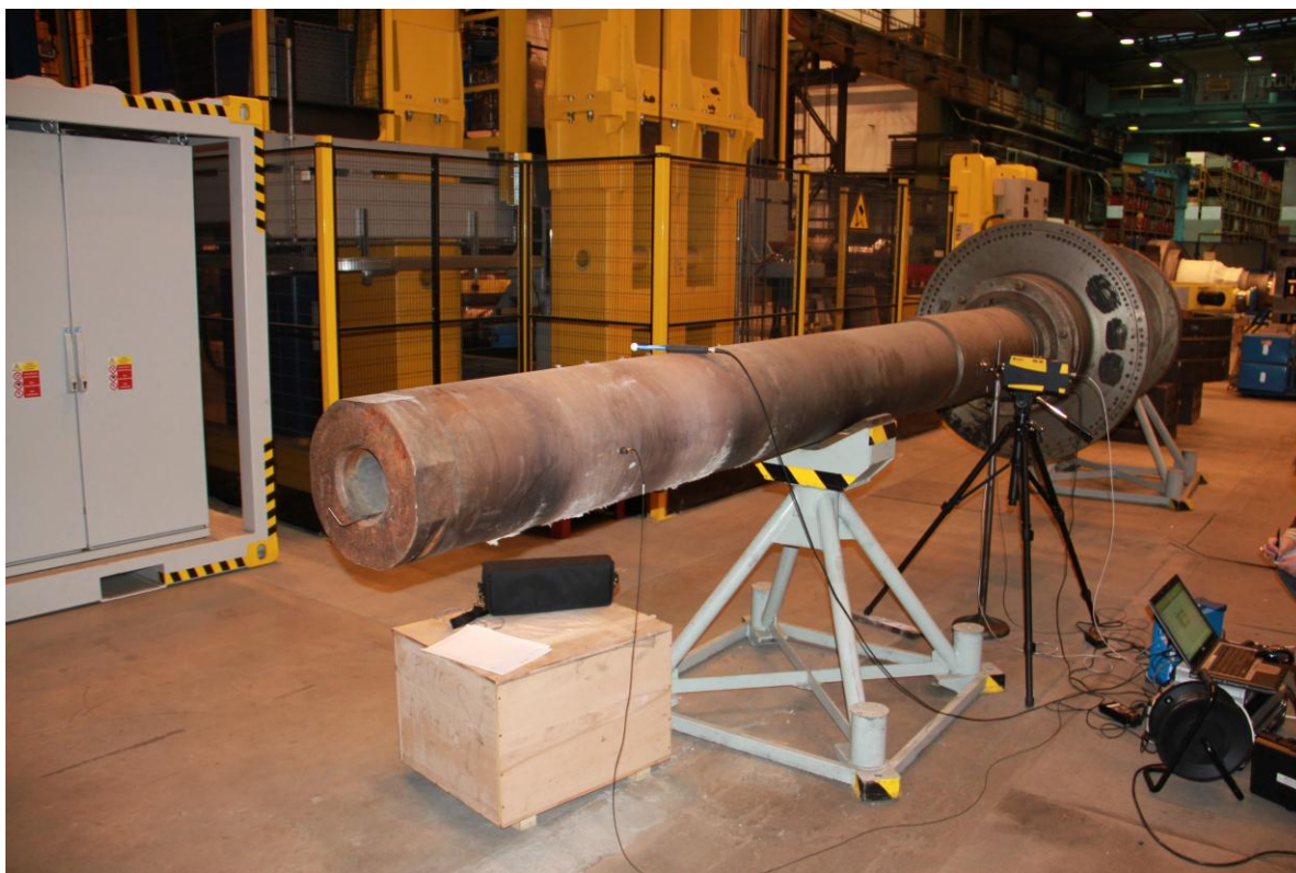
obr. A-1: Experiment na rotoru bez otáček
