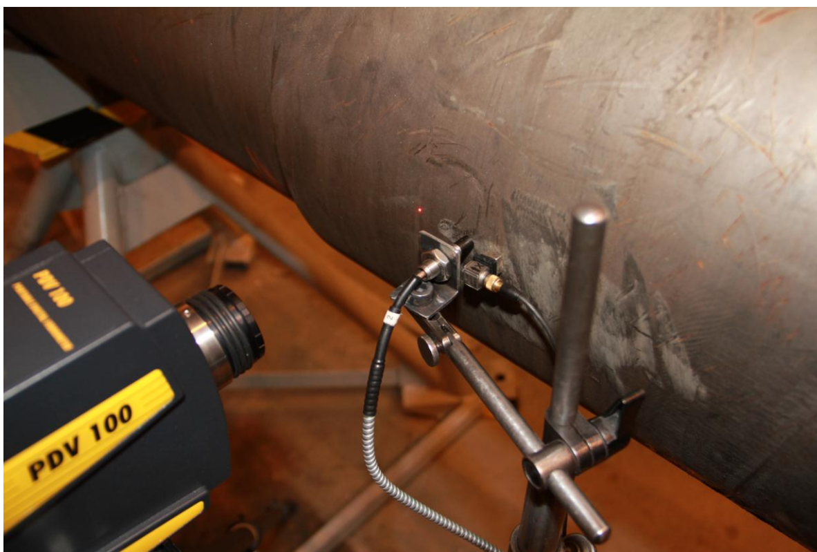
obr. A-2: Umístění snímačů na rotoru
