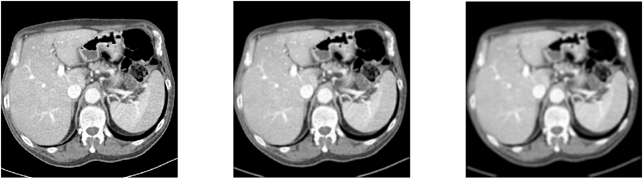
Obr. 3.1: Původní obraz (vlevo), aplikovaný klouzavý průměr s maskou 5x5 (uprostřed) a maskou 9x9 (vpravo).
