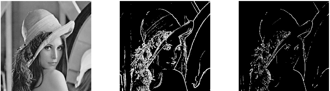
Obr. 3.11: Původní obraz (vlevo), hranová detekce pomocí Sobelova operátoru s prahem 5% (uprostřed) a prahem 10% (vpravo).
