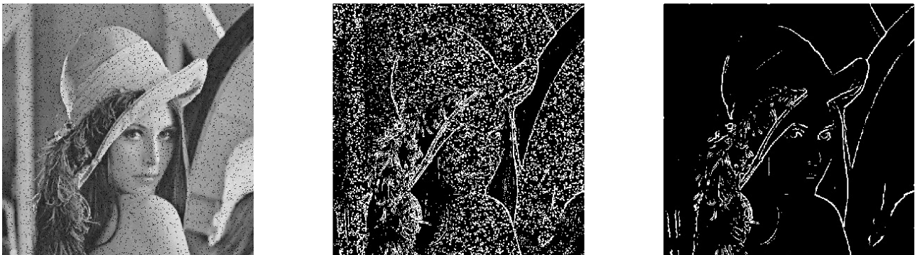
Obr. 3.8: Původní "zašuměný" obraz (vlevo), detekce hran na původním obrazu (uprostřed), obraz nejprve zbaven šumu mediánovým filtrem (vpravo).
