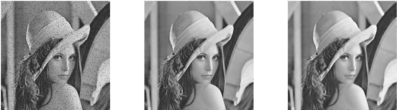
Obr. 3.3: Původní obraz zatížený šumem salt & pepper (vlevo), šum odstraněný mediánovým filtrem s maskou 3x3 (uprostřed) a 5x5 (vpravo).
