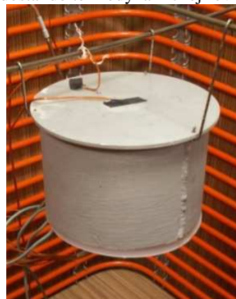
Obr. 3: Model elektrostatického meniča bez chladiča
