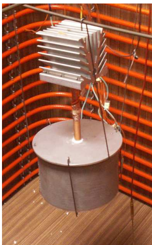
Obr. 5: Model elektrostatického meniča s tepelnou trubicou a rebrovaným chladičom
