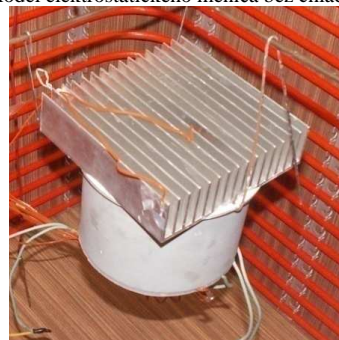
Obr. 4: Model elektrostatického meniča s rebrovaným chladičom
