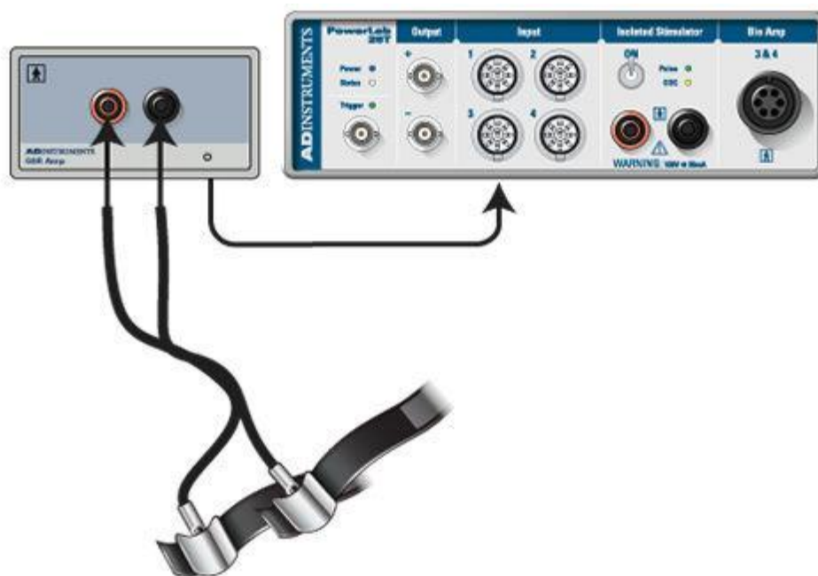
Obrázek 14 PowerLab 8/30 se zesilovačem ML 116 GSR Amp a elektrodami. Staženo z www.adinstrument.com
