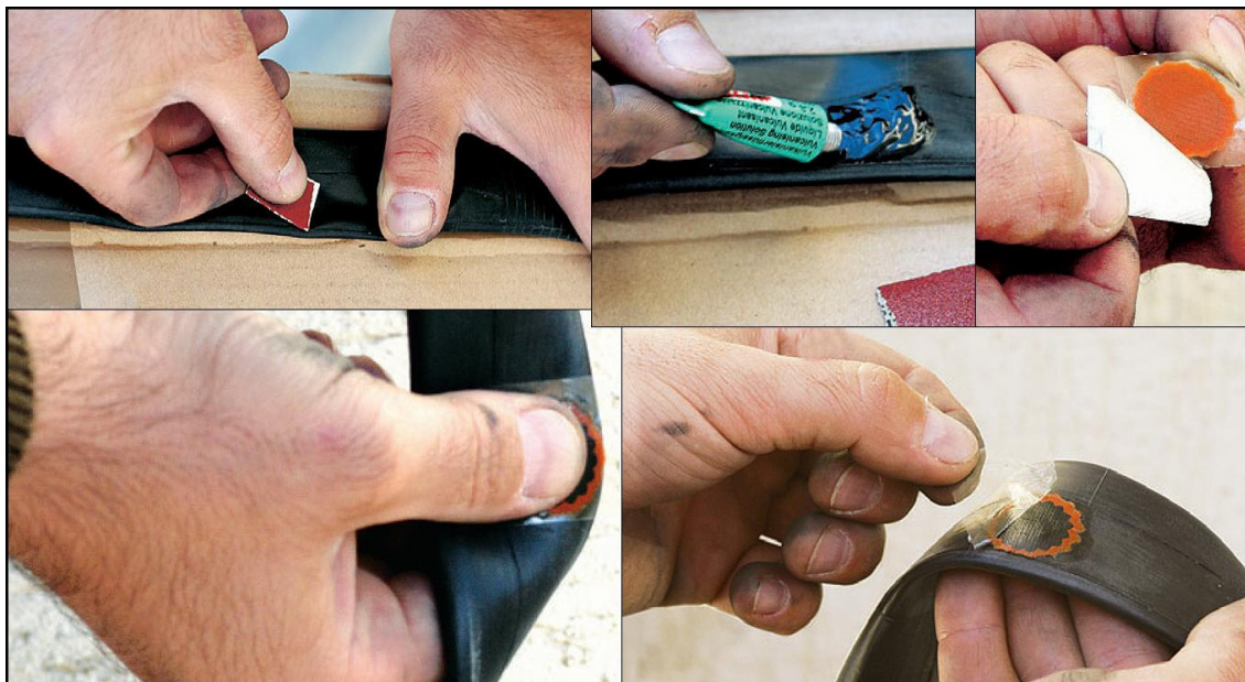
Obrázek 6 - Návod lepení děravé duše (Originál z iVelo.cz, upraveno)
