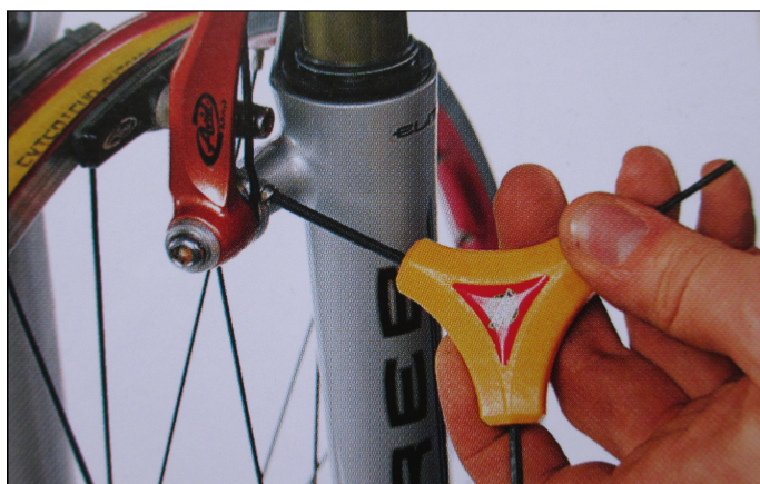
Obrázek 11 - Seřízení brzdy (HAYMANN, STANCIU 2009, s. 89, upraveno)
