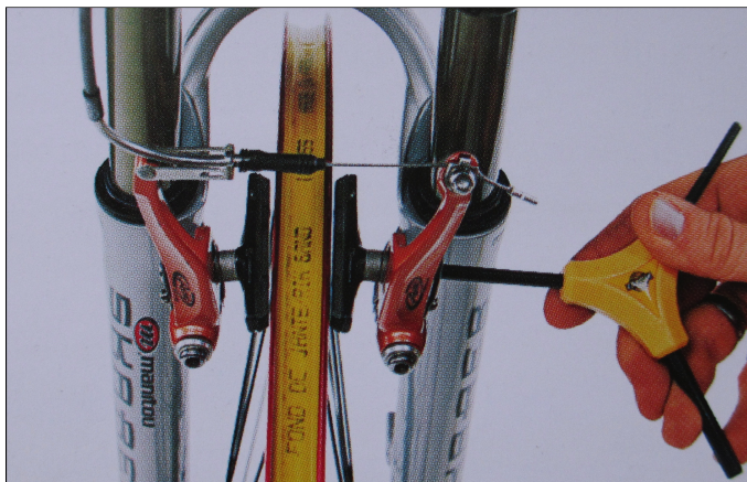
Obrázek 10 - Seřízení brzdy (HAYMANN, STANCIU 2009, s. 89, upraveno)
