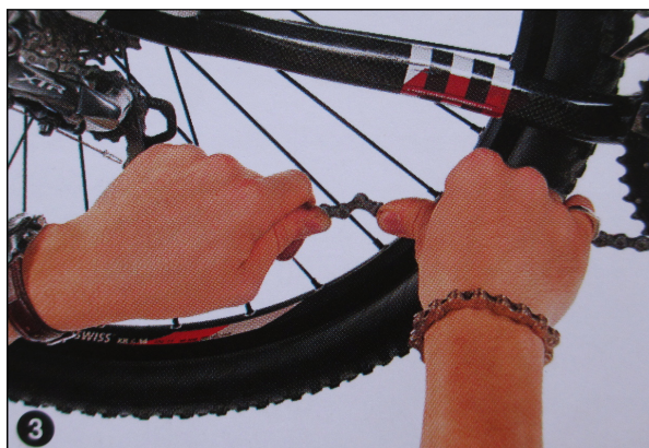
Obrázek 9 - Výměna/oprava řetězu (HAYMANN, STANCIU 2009, s. 88, upraveno)
