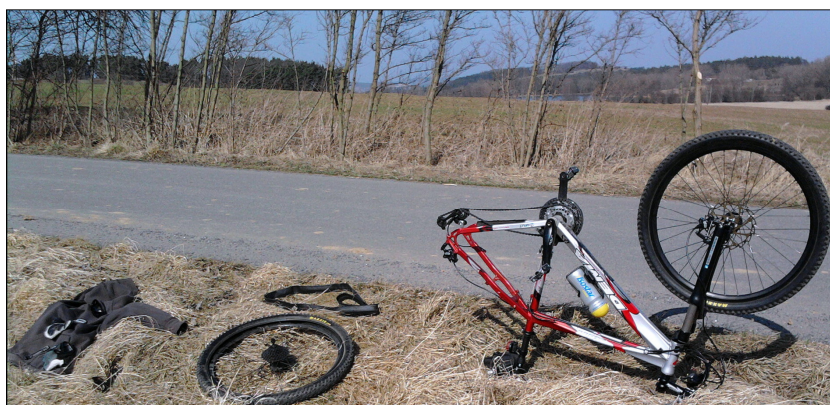
Obrázek 3 - Oprava defektu (Vlastní fotografie)
