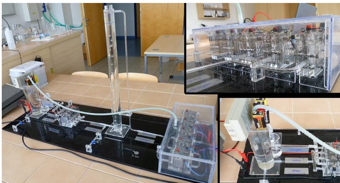
Obrázek 6.4: Aplikace kyslíkového krytu. (pozn. baterie na obrázku slouží jen jako hmotnostní zátěž pro lepší plynost na vstupu kyslíku do gumové hadičky)
