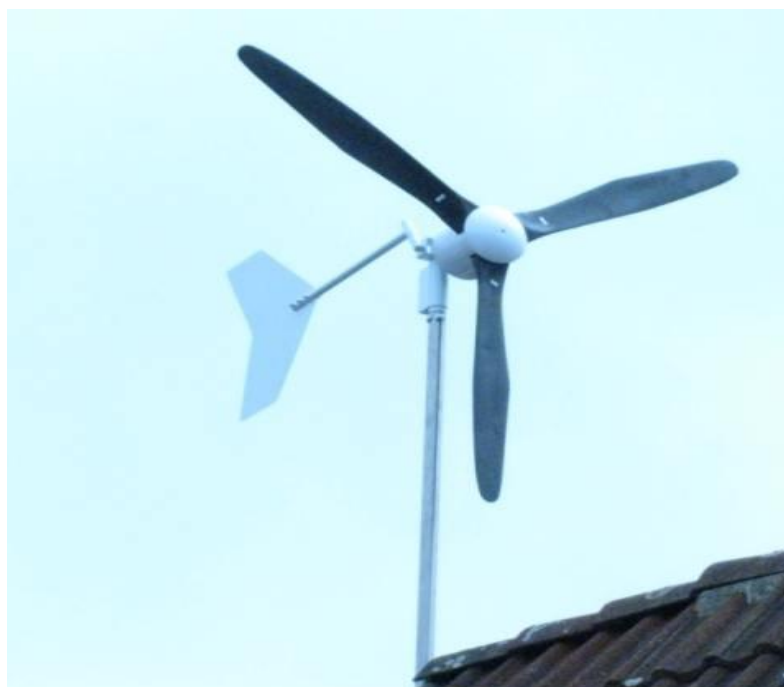
Obr. 3.4 Větrná elektrárna model Black Wind Generator 600 12 / 24 V [15]
