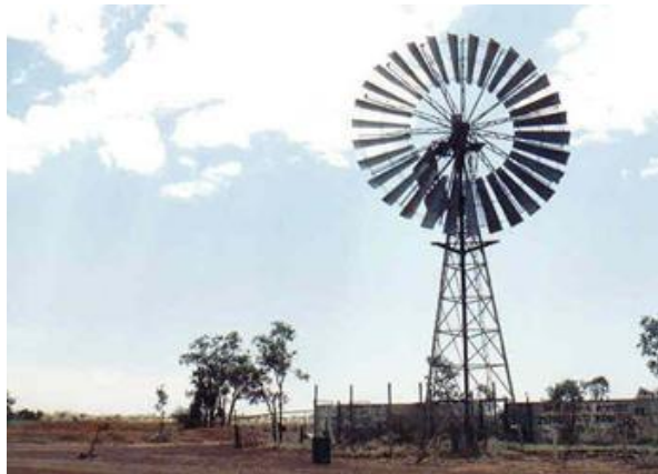
Obr. 1.9 Westernové kolo na čerpání vody [3]
