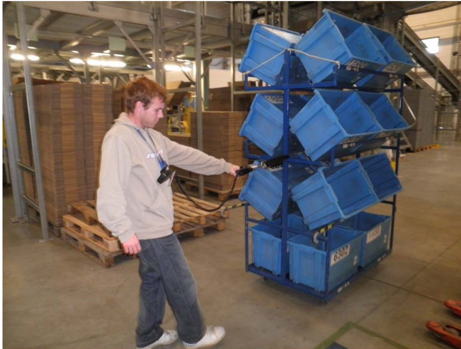
Obrázek 4-2 Použití sady ergoPAK na změření tažných sil působených na „trolley“
