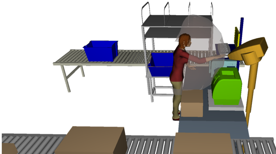
Obrázek 4-12 Pracovní pozice – dosah PC (výška pracovnice 175cm)
