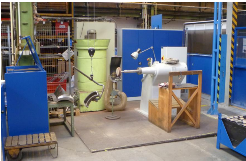
Obrázek 2-10 Pracoviště pro ruční leštění lopatek na hale
