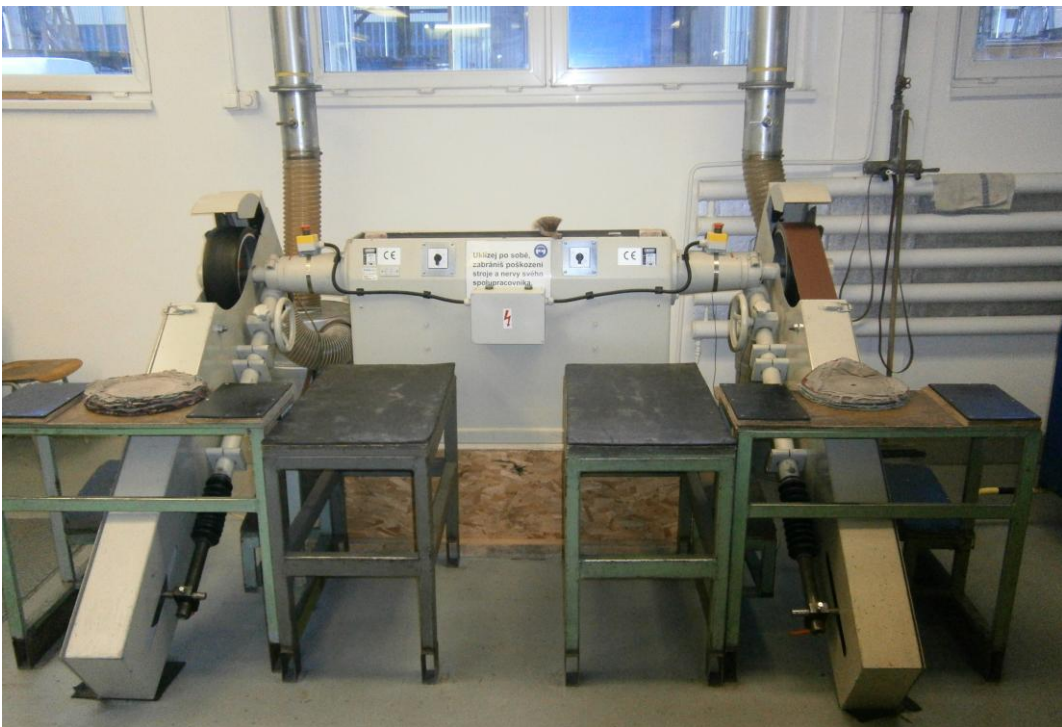
Obrázek 2-12 Pásové brusky v prostoru leštičkárny
