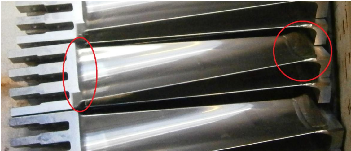
Obrázek 3-10 Lopatka s vyznačenými místy broušení
