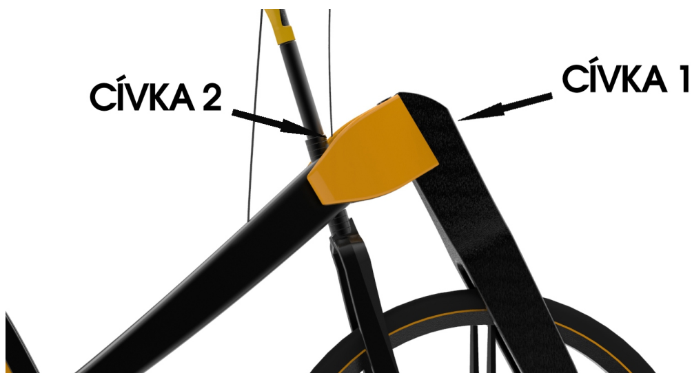
Obr. 19:rozmístění cívek, které zprostředkovávají indukční dobíjení 19
