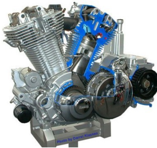
Obr. 2.2. Příklad 4-taktního motoru chlazeného vzduchem [17]
