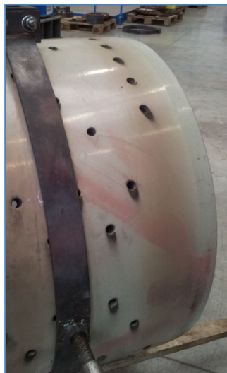
Obr. 2: Ukázka znečištění ve vzduchovém chladicím systému
