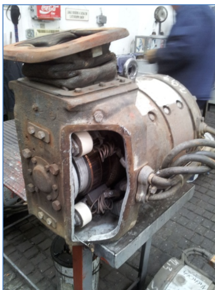
Obr. 15: Ukázka demontovaného špinavého motoru před čištěním
