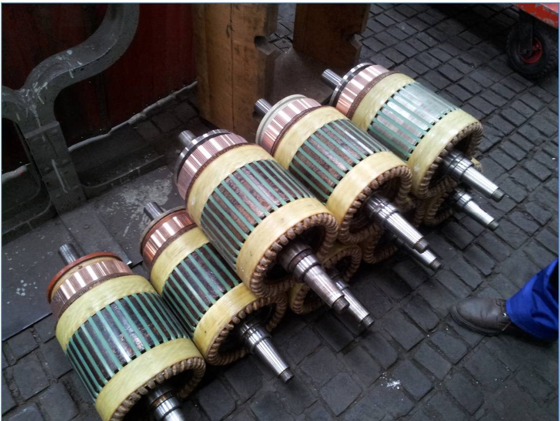
Obr. 17: Vyčištěné a převinuté rotory
