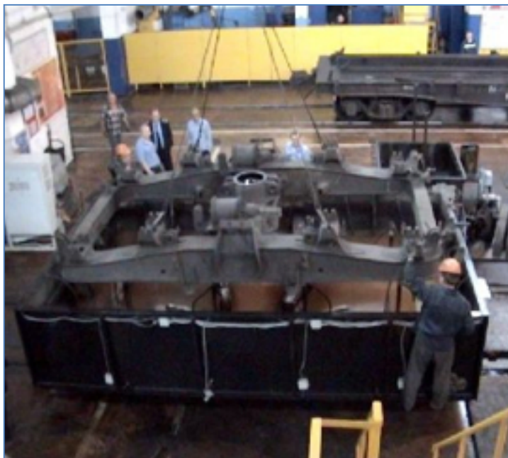
Obr. 11: Ukázka čištění s modifikovatelnou vanou, převzato z [13]
