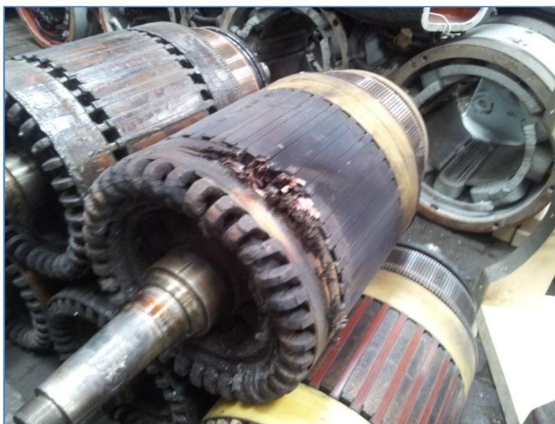
Obr. 16: Ukázka následku zkratu na rotoru motoru
