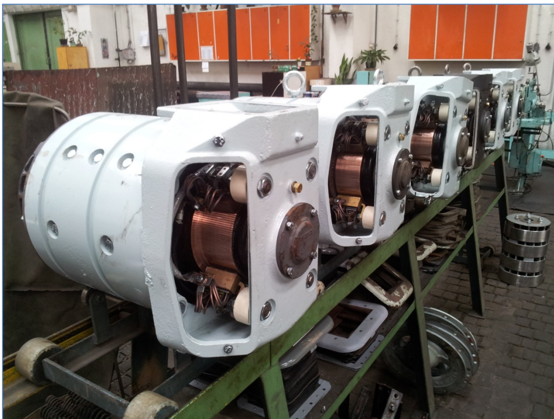
Obr. 19: Vyčištěné a zkompletované motory připravené na montáž do souprav
