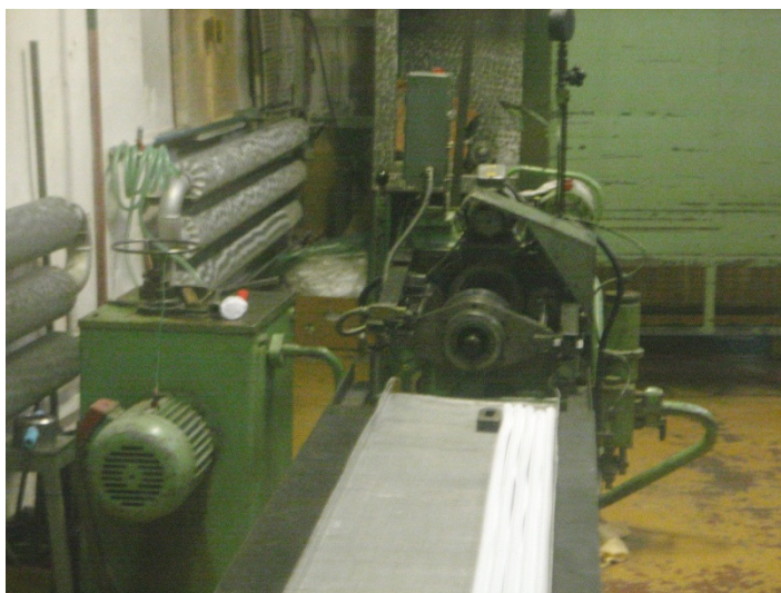
Obr. 4: Stroj pro technologii vytlačování z pasty [7]
