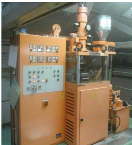
Obr. 5: Horní část stroje pro pístové vytlačování [7]
