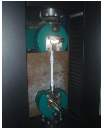
Obr. 18: Tahová zkouška technologického vzorku
