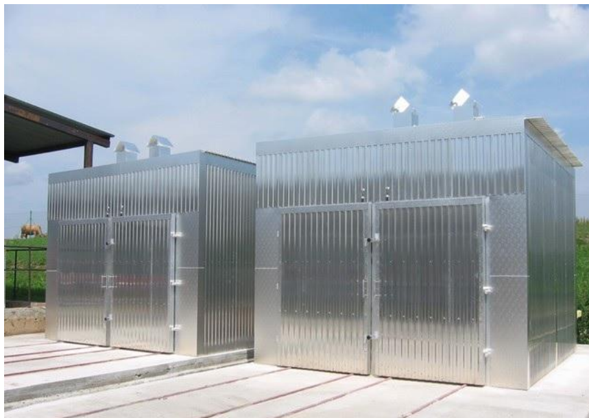
obr. 12: Komerové sušárny řeziva typu SR s kolejnicovou zavázkou řeziva; převzato z [21]
