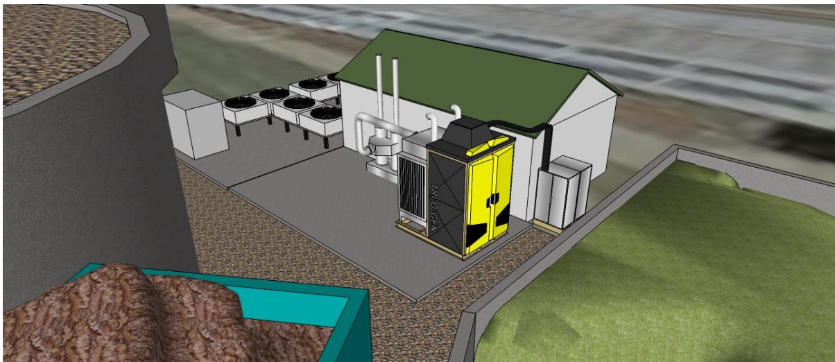
obr. 17: Situace objektu s KGJ a vhodného umístění ORC jednotky včetně napojení na výfukovou soustavu
