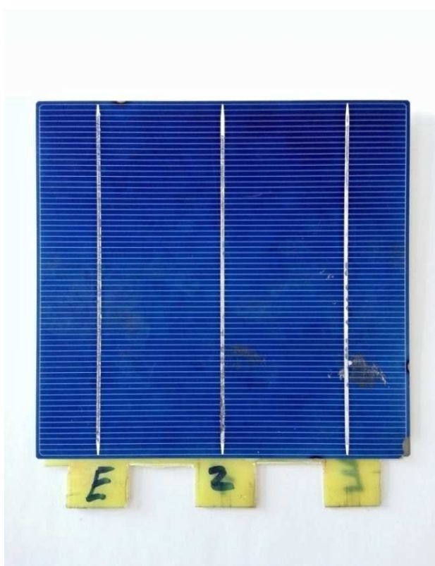
Obr. E-2 Solární článek po testování pevnosti v tahu
