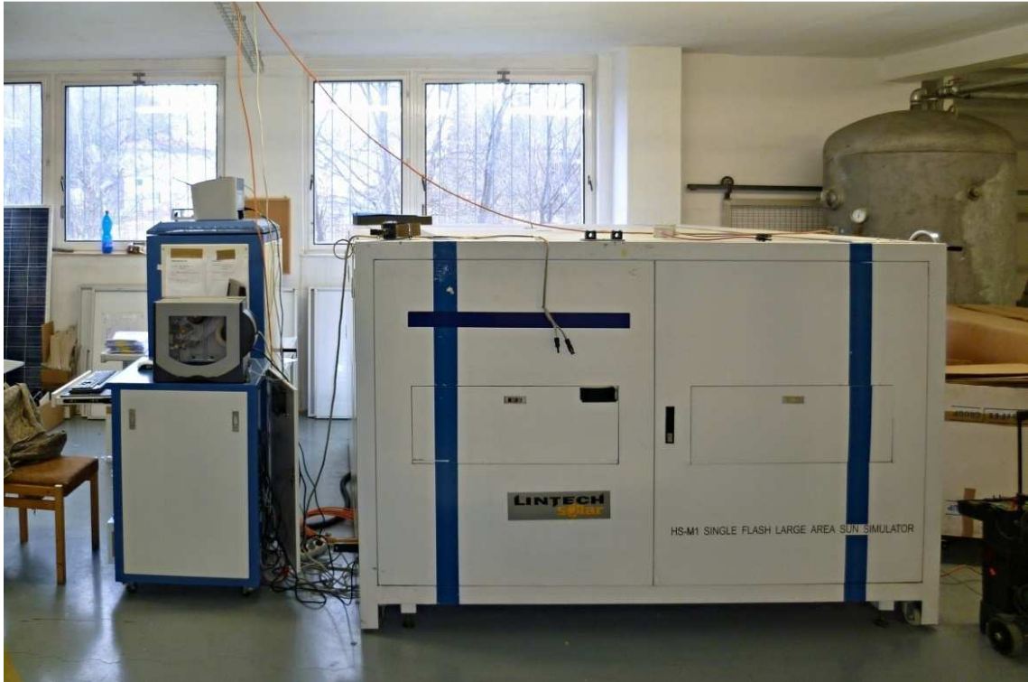
Obr. A-11 Jednotka pro měření a testování nových FV panelů
