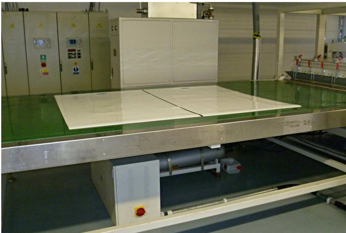
Obr. A-7 Vstupní dopravník, proces posuvu a rovnání polotovaru před laminací
