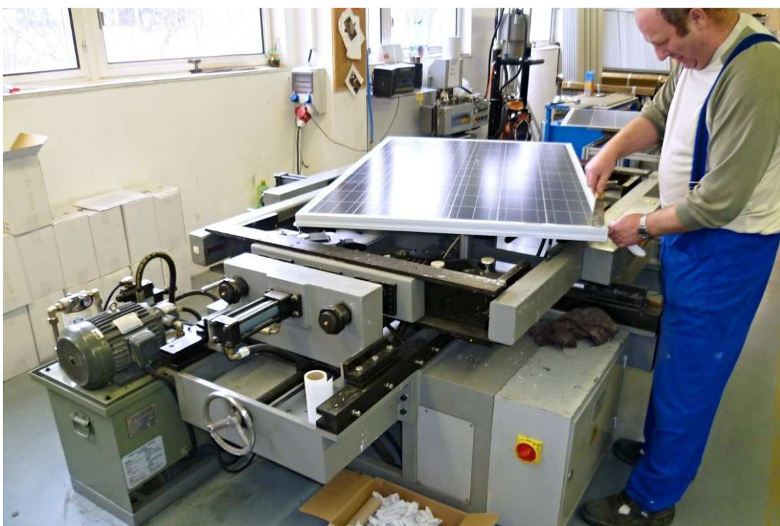
Obr. A-10 Rámování (framing) a nově vzniklý FV panel (netestovaný)
