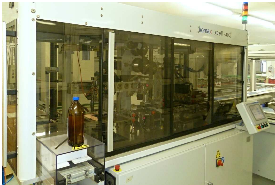
Obr. A-2 Zařízení na proletování solárních článků
