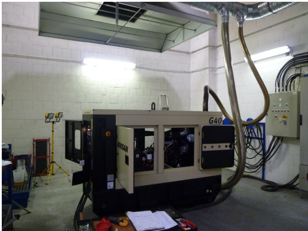
Obr. 2.2 Testovaný generátor ve zkušebně společnosti AIR POWER 23
