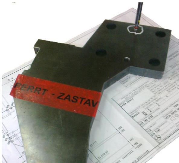
Obr. 19 - Neshodná pozice: tolerance otvoru
