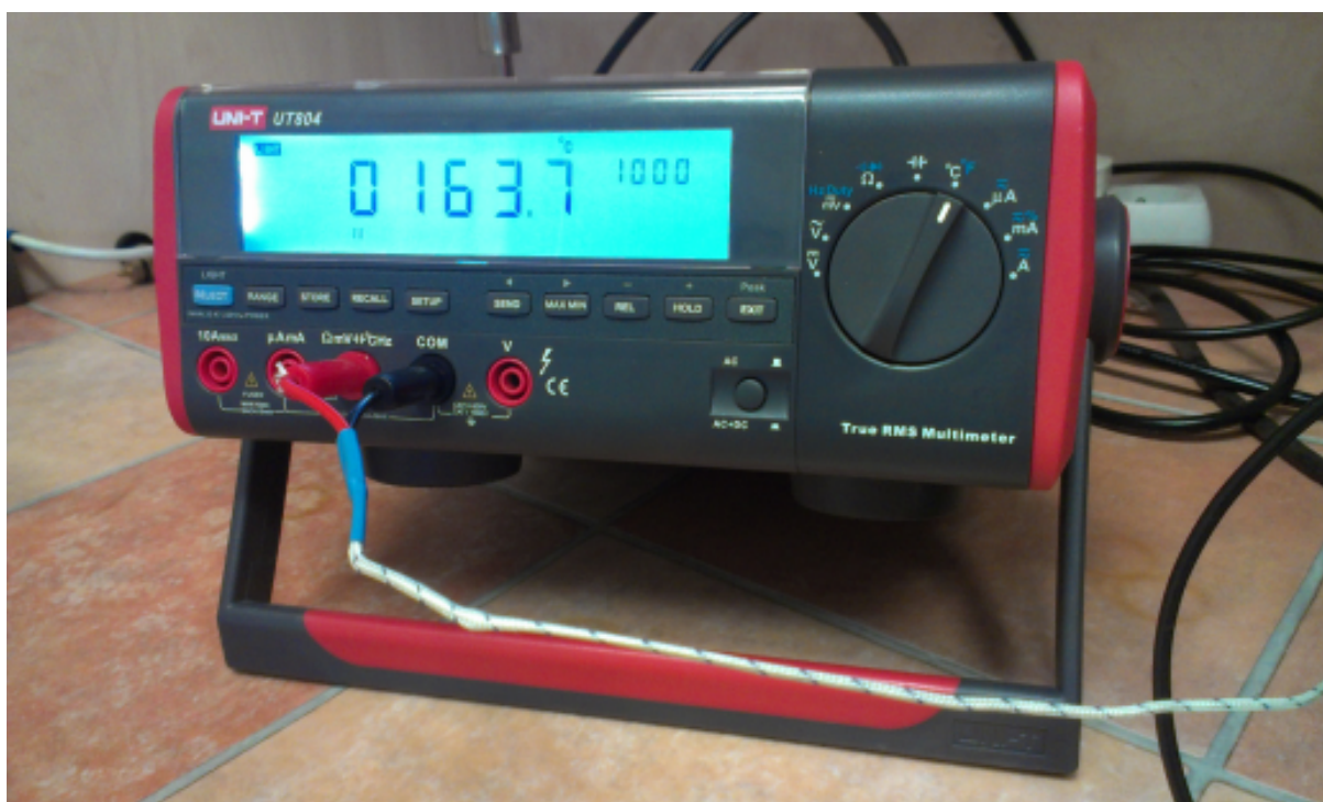
Obr. 28 Digitální multimetr UNI - T UT804 s teplotou silikonového oleje
