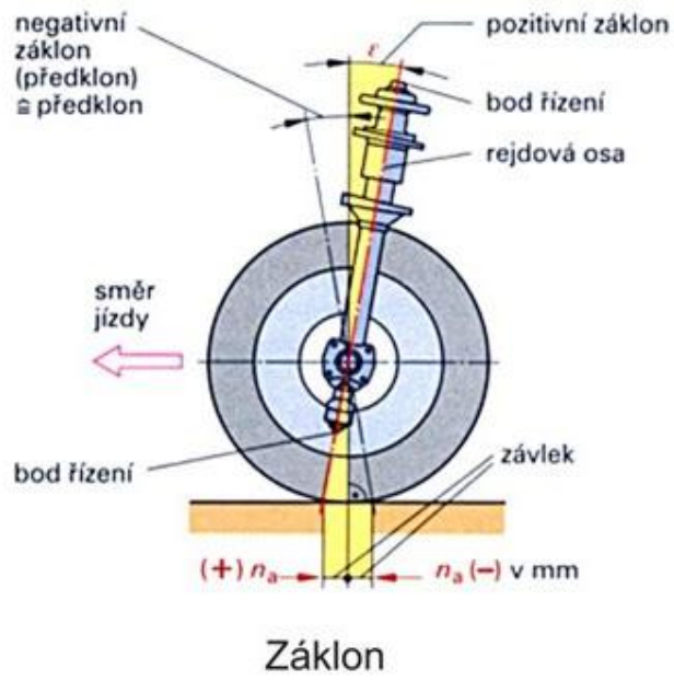
Obrázek 20 - Závlek a záklon rejdové osy [9]
