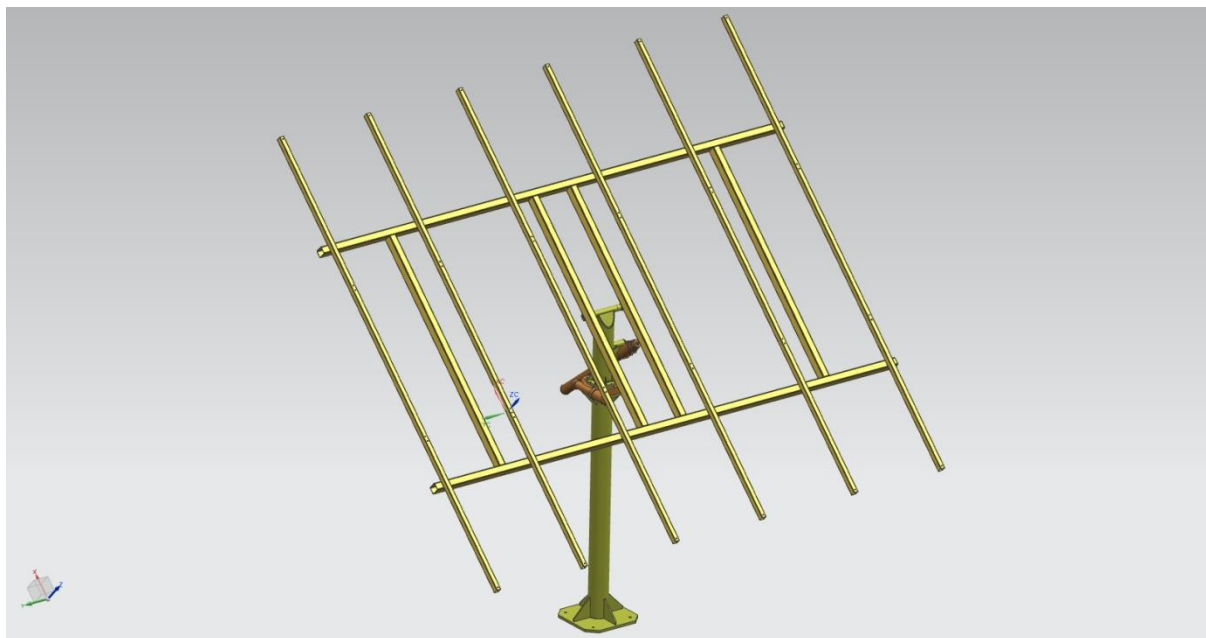
Obr. 21 Pohled na konstrukci s dvouosou rotací
