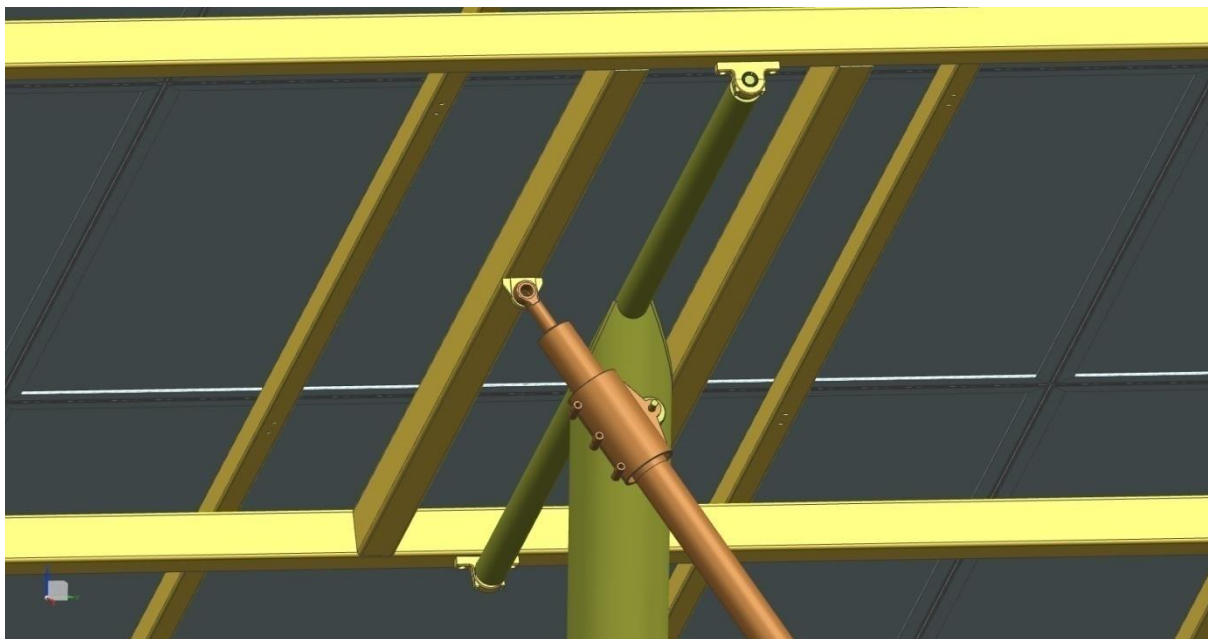
Obr. 20 Pohled na ložiska a lineární pohon
