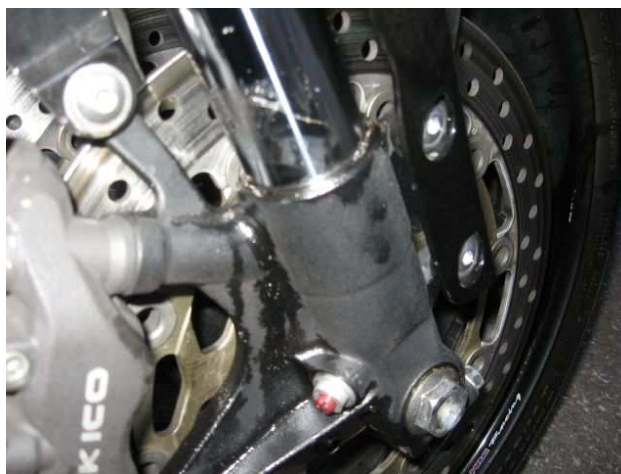
Obrázek 3-43 Olej prosakující na brzdový kotouč [32]
