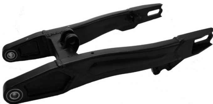
Obrázek 3-27 Kyvná vidlice s dvěma rameny [25]
