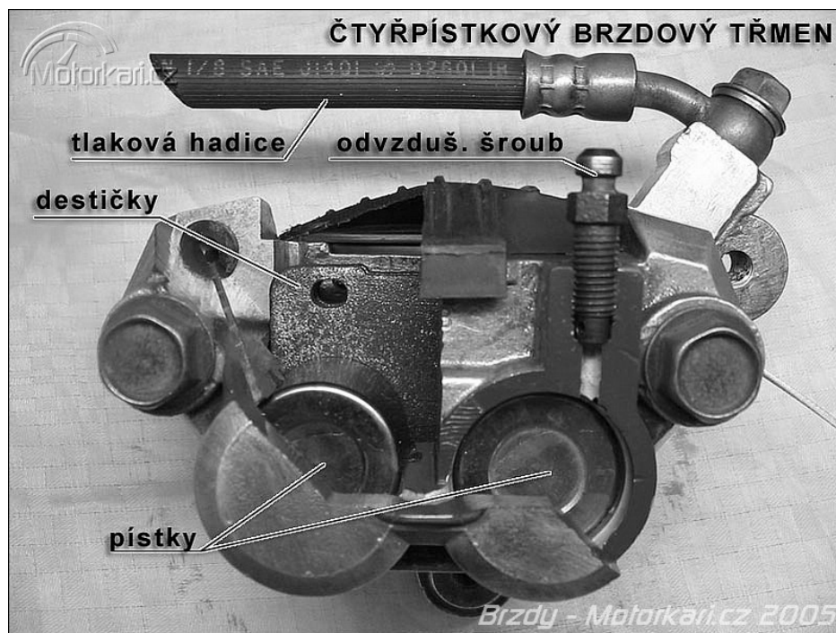
Obrázek 3-38 Konstrukce brzdového třmenu[31]
