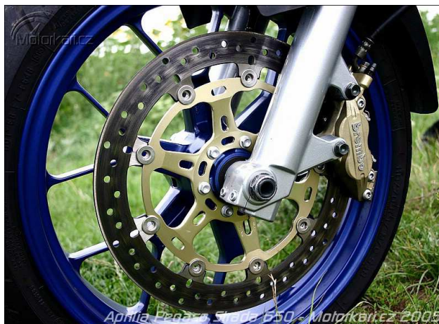
Obrázek 3-39 Kotoučová brzda s pevným brzdovým třmenem a plovoucím kotoučem [31]
