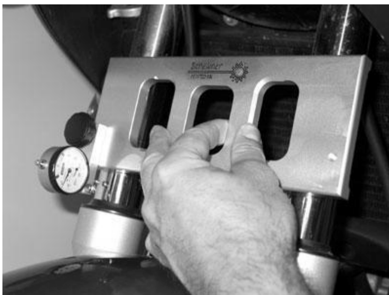
Obrázek 3-18 Ukázka měření s F.e.in gauge [17]
