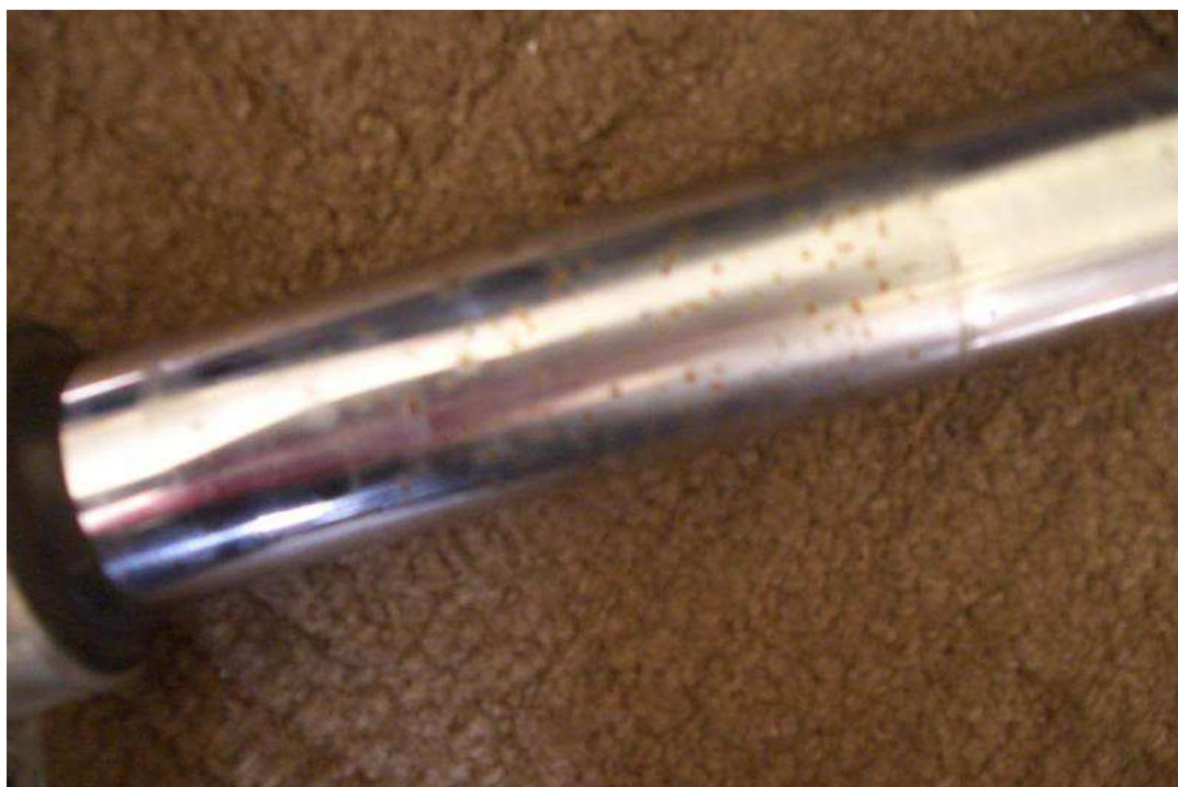
Obrázek 3-23 Poškozená vidlice od kamínků a rzi [23]
