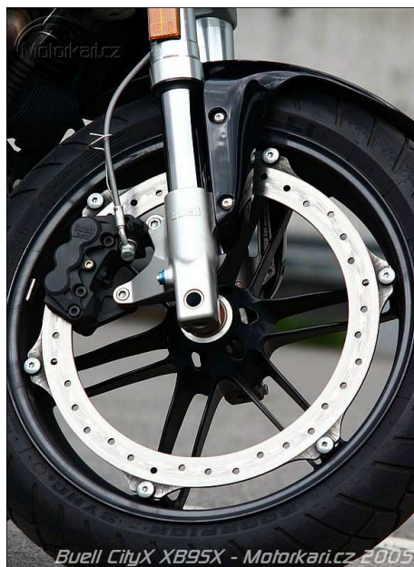
Obrázek 3-40 Kotoučová brzda s pevným obvodovým kotoučem a šestipístovým brzdovým třmenem [31]
