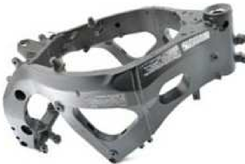
Obrázek 3-3 Rám typu deltabox [12]
