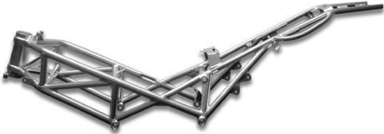
Obrázek 3-4 Trubkový příhradový rám [13]
