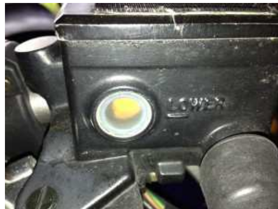
Obrázek 3-42 Kontrolní otvor hladiny brzdové kapaliny na brzdovém válci se sdruženou zásobní nádobkou [34]
