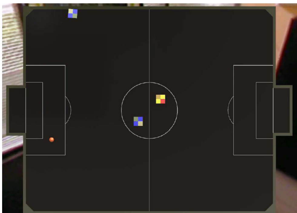
Obrázek B.1: Na snímku generovaném perspektivní projekcí (nahore) jsou vidět i stěny robota a hřiště. Ve snímku generovaném ortogonální projekcí je vidět pouze identifikační štítek a horní plochy stěn hřiště (obrázek dole).
