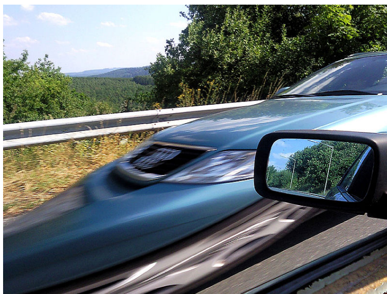
Obrázek B.3: Artefakt vznikající u CMOS čipů ve snímacím módu Rolling Shutter . U rychle pohybujícího se předmětu dochází ke zkosení vlivem postupného čtení jednotlivých řádků obrazu ze senzoru v různých časových okamžicích.
