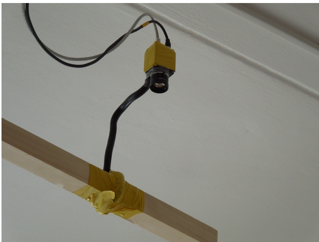
Obrázek B.5: Detail připevnění kamery. Kamera byla umístěna na dřevěnou konstrukci do výšky zhruba 2,5 metru nad hřištěm a připevněna na kabel tak, aby se dala snáze polohovat. Její pozice byla nastavena tak, aby ve snímku byl vidět celý hrací stůl a hrany stolu byly zobrazeny zhruba rovnoběžně s osami snímaného obrazu.
