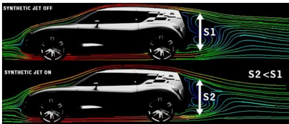
obr. 2-8: Použití syntetizovaného paprsku u automobilu Renault Altica [23].
