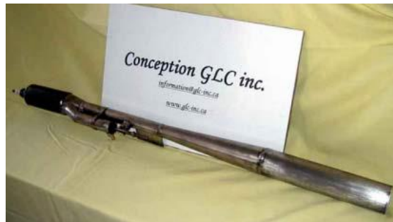
Obr. 18 Chinese CS pulzační motor od společnosti GLC inc.
