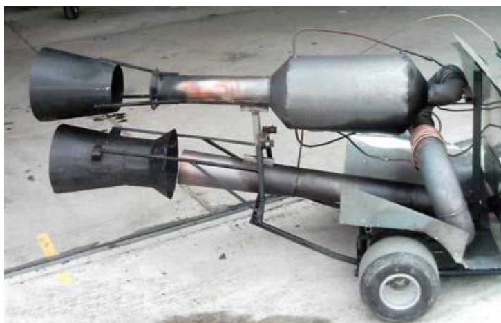
Obr. 14 Aglomerační trubky na bezventilovém pulzačním motoru
