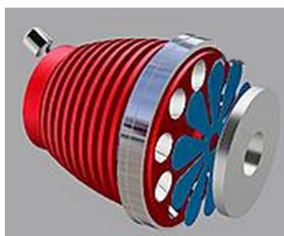
Obr. 27 Listový ventil na difuzoru
