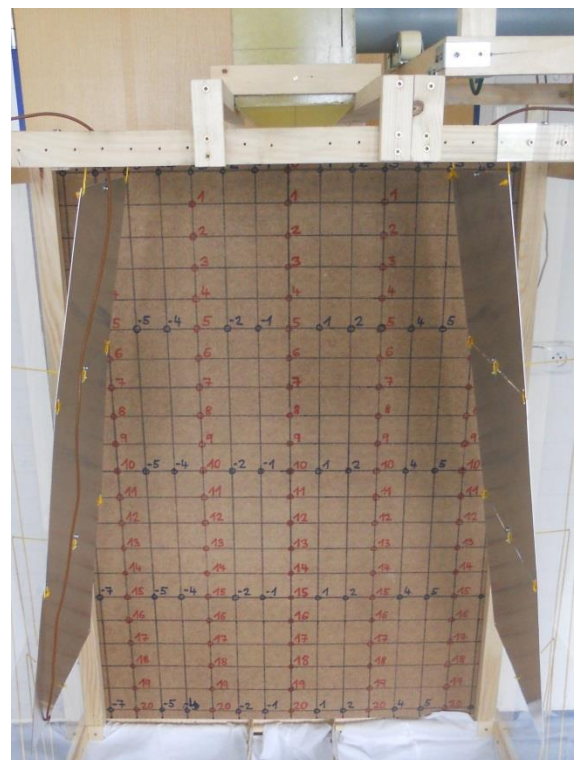
Celkový pohled na separátor, systém elektrod a za nimi umístěný rastr
