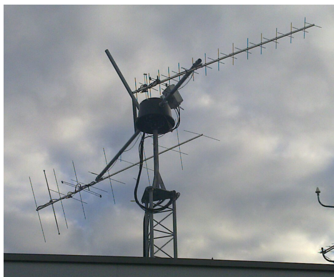
Obr. 3.1: Antény typu Yagi a anténní rotátor umístěné na střeše budovy FEL ZČU.
