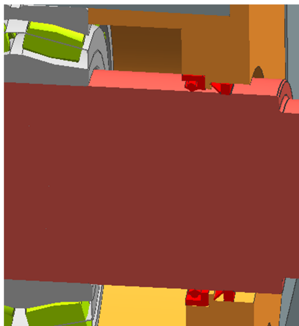
Obr. 7-10 Těsnění řešené guferem a v-kroužkem
