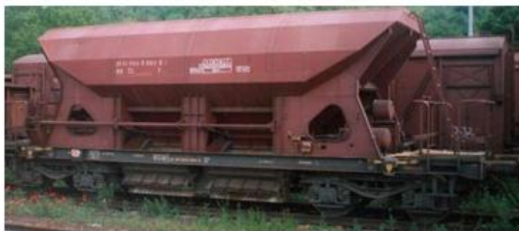
Obrázek 1. Vůz s podlahou tvaru V (X) - vykládka na levou nebo pravou stranu (Faccs) [5]
