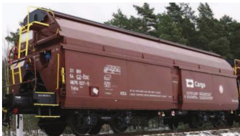
Obrázek 16. Čtyřnápravový výsypný vůz s přesuvnou střechou (Talls)
