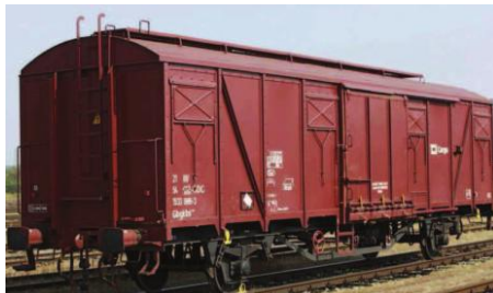
Obrázek 14. Dvounápravový krytý vůz běžné stavby (Gags) - pevná celistvá střecha
