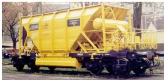
Obrázek 4. Vůz s nízko položenými klapkami dovnitř i vně koleje - tvar podlahy W (Facepps) [5]
