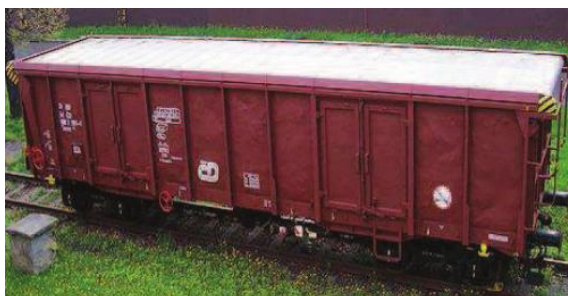
Obrázek 17. Čtyřnápravový vysokostěnný vůz s přesuvnou plachtovou střechou (Tams)
