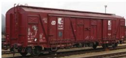
Obrázek 15. Čtyřnápravový krytý vůz zvláštní stavby se střešními násypnými otvory (Hads) – pro přehlednost přiložen typový výkres
