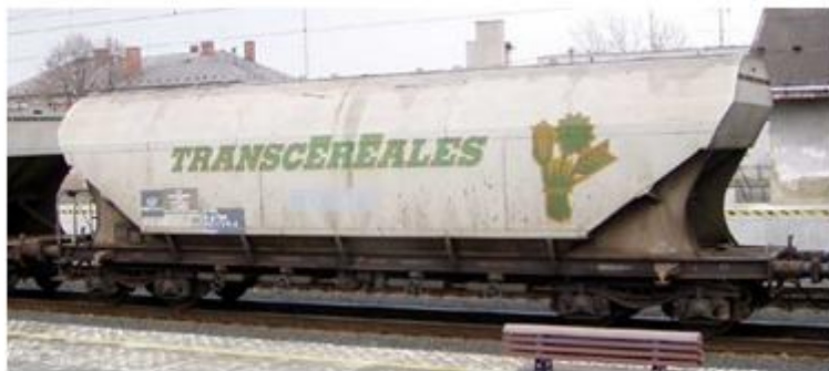
Obrázek 2. Vůz s podlahou tvaru V se středovými klapkami (Uagps - posuvné klapky) [5]
