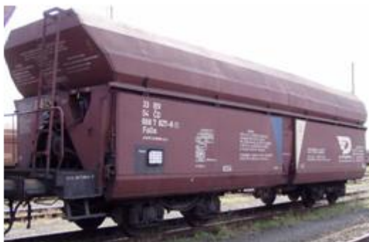
Obrázek 3. Vůz s podlahou tvaru W - "wapka" (Falls) [5]
