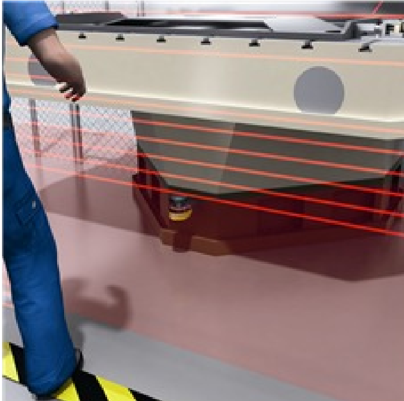
Obr. 32 Příklad použití opticko-elektrických světelných závor SICK [10]
