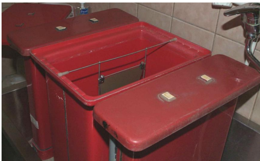
Obr.č.34 Film v rámečku ve vyvolávacím tanku (ukázka bez chemikálií)
