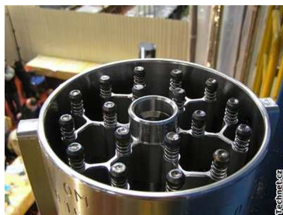
Obr. 6 Odpružené uchycení palivových proutků firmy OKB GIDROPRESS [I]
