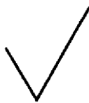
Obr. 2 Základní grafická značka pro strukturu povrchu [16]
