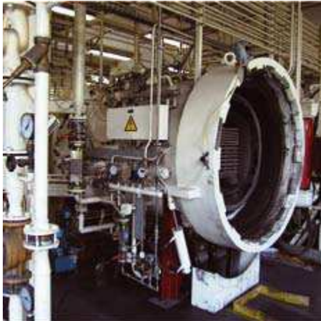
Obrázek 4-2 pec pro slinování karbidů [8]
