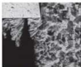
obsah síry 0,17 % - zvýšená lámavost třísky
